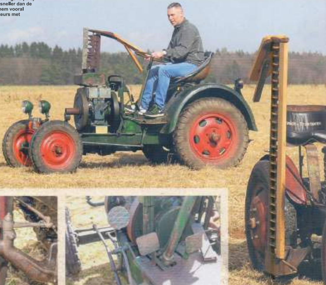
Slimme oplossing: de chauffeur activeert de voorrem via een stang. Bij de diesel via een hendel, bij de benzineuitvoering .....
