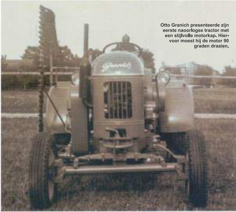
De groene benzinemotor brengt 12 pk op het veld en is beduidend sneller dan de dieselversie. Dit maakte hem vooral populair bij wegtransporteurs met aanhangers.
