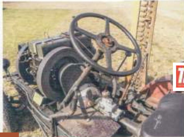
De Granich is gebouwd op een uitgesproken solide frame. Zowel de besturing als de remmen komen uit het modulaire systeem van Opel automobielen.
