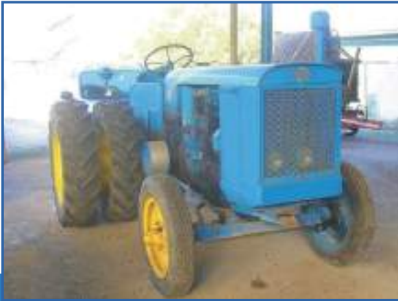
Een SIFT TP 60 met een vermogen van 60 pk. De blauwe kleur is niet origineel.
