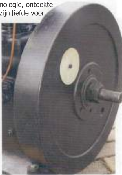
Solide vliegwiel, maar bij de motoren uit de eerdere jaren voorzag het bedrijf het vliegwiel van spaken van gietijzer.
