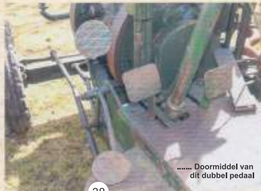
Slimme oplossing: de chauffeur activeert de voorrem via een stang. Bij de diesel via een hendel, bij de benzineuitvoering .....
