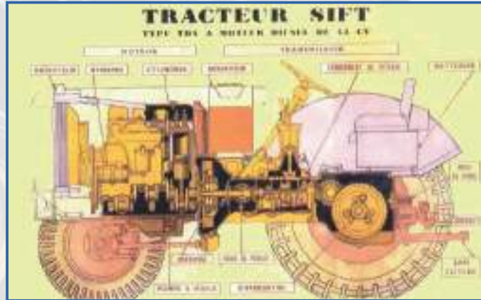
Dwarsdoorsnede van een TD4 met een viercilindermotor van 43 pk.
