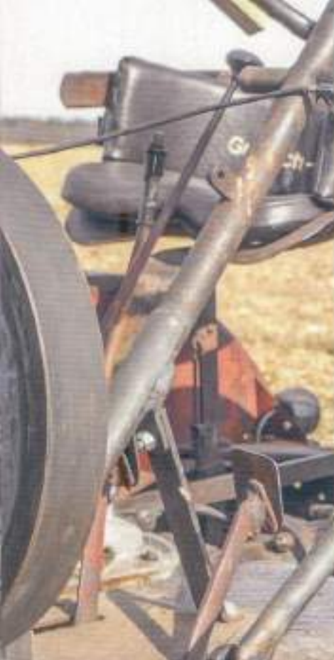
De Granich is gebouwd op een uitgesproken solide frame. Zowel de besturing als de remmen komen uit het modulaire systeem van Opel automobielen.
