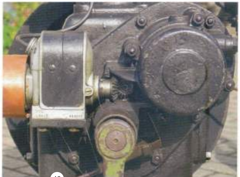
De ingebouwde centrifugaalregelaar bepaalt de snelheid in de magneetontsteking via de tandwielen.
