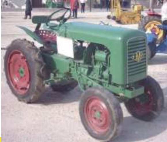
De grotere T6 was uitgerust met een 2-cilinder viertaktmotor van 630 cm 3 met een vermogen van 15 pk, later opgevoerd tot 17 pk. Hij was bovendien uitgerust met een hydraulische herinrichting, aftakas, differentieel-blokkering enz.
