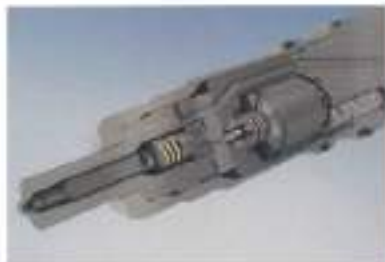
Het injectiemondstuk en mondstukhouder zijn meerdelig. Als de plaag zich hierin heeft gevestigd, moet de specialist deze meestal repareren.
