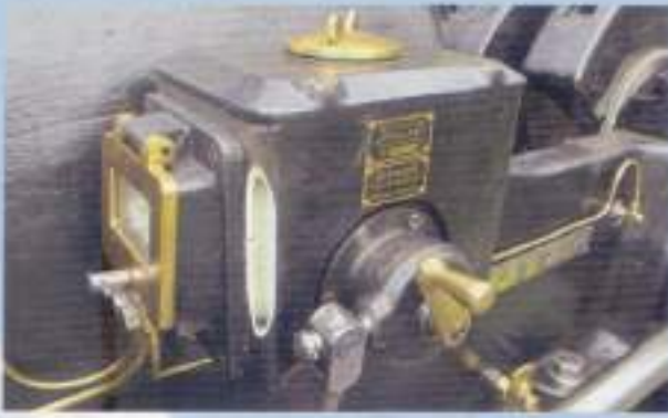
De Deutz smeerpomp "Gritzner systeem" transporteert de olie direct naar de smeerpunten. Controleren is altijd mogelijk dankzij het kijkglas
