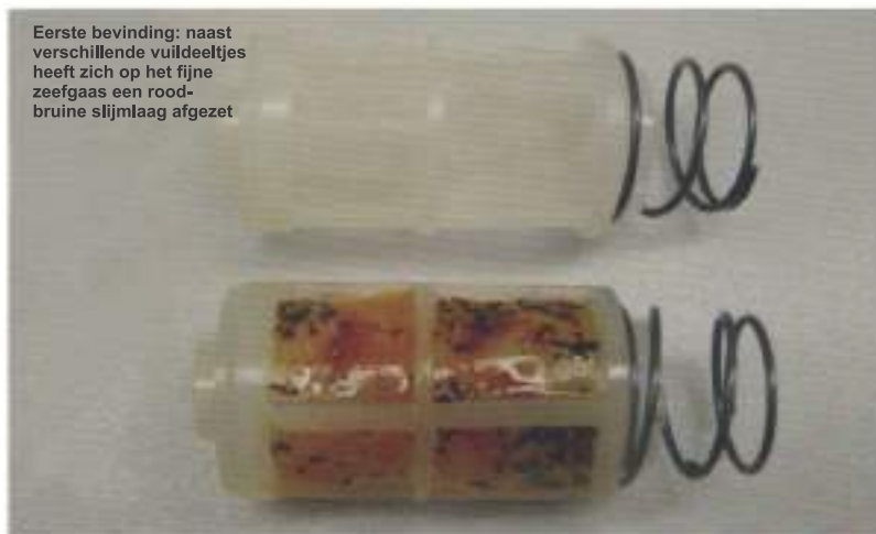
Massale aantasting: dit filterelement is al volledig overgroeit door de gelatine-achtige afbraakproducten van de micro-organismen.
