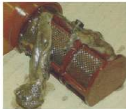
Massale aantasting: dit filterelement is al volledig overgroeit door de gelatine-achtige afbraakproducten van de micro-organismen.
