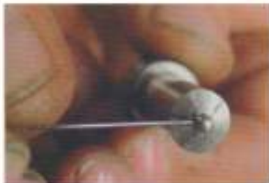
Niet elke sleutelaraar heeft de juiste apparatuur om het vuil uit de spuitmondgaten te verwijderen
