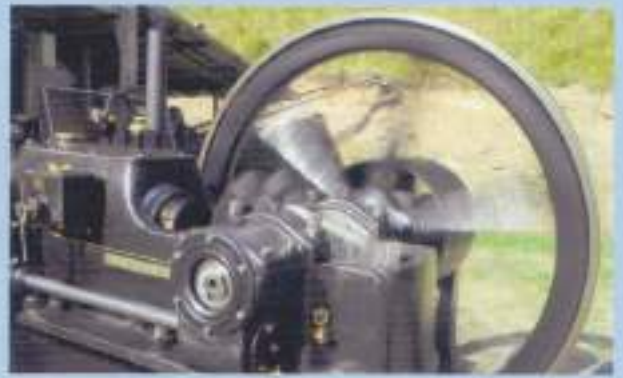
Massa in beweging: het 1,6 meter grote vliegwiel van één ton zorgt voor een rustige loop en een gelijkmatige vermogensafgifte
