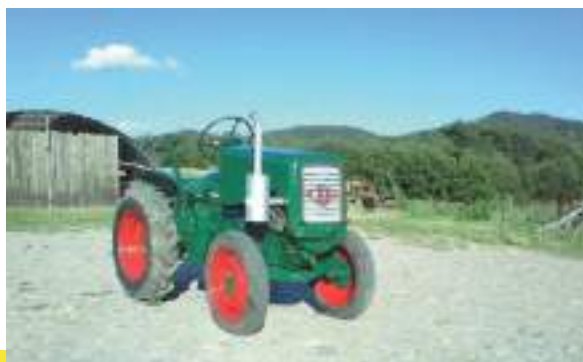
In 1950 werd de T5 tractor geïntroduceerd, de T4 diende hier als basis. De T5 was uitgerust met een LMP eencilinder viertaktmotor met een inhoud van 630 cm 3 en een vermogen van 12 pk aan de riemschijf en 7pk aan de trekhaak.
