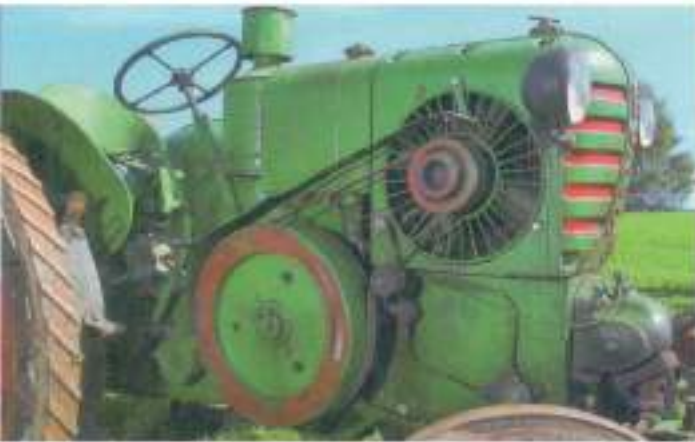
Riemaangedreven ventilator, relatief kleine centrifugaalmassa's aan beide zijden: de HSCS-gloeikop vereiste iets hogere toerentallen dan een vergelijkbare Lanz-motor. Het komt ook niet helemaal overeen met de werking van de Mannheim.
