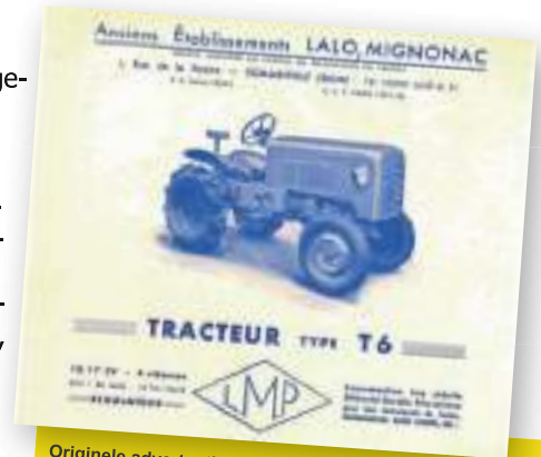
Originele advertentie voor de LMP T6 trekker. 15 en 17 pk, 4 versnellingen waarvan 1 baanversnelling en een topsnelheid van 18 km/u vermeldt de advertentie.
