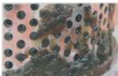
Op het eerste gezicht lijkt het wel oud smeervet. Maar in het filter, waar deze "pudding" blijft plakken, heeft smeren toch helemaal geen zin?
