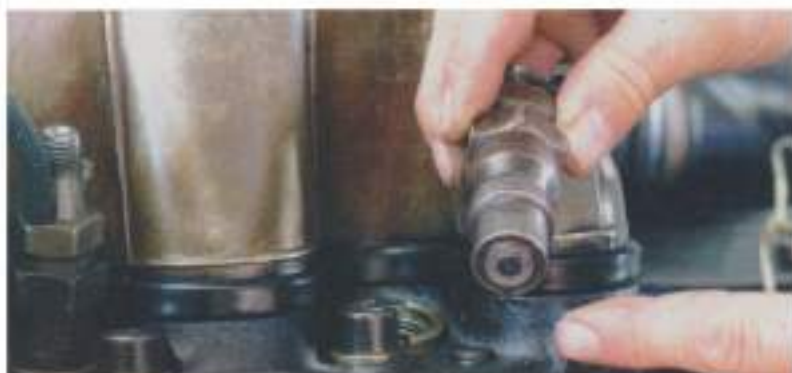
De verstopping kan zich uitstreken tot aan de punt van het mondstuk. Controleren of er nog iets door komt kan alleen met een speciaal apparaatje tijdens een zogenaamde jetttest. Op een draaiende tractor is dat veel te gevaarlijk, aangezien dieselstralen gemakkelijk door de huid kunnen schieten en tot levensbedreigende bloedvergiftiging kunnen leiden. Als de tractor ondanks een filterwissel niet start, wordt eerst een injectieleiding gedemonteerd en gecontroleerd op continuïteit
