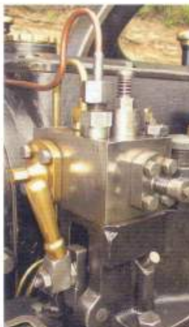
Perfekte mechanica: Ralf Funke moest eerst de injectiepomp begrijpen, daarna begon hij met succes aan de restauratie ervan.
