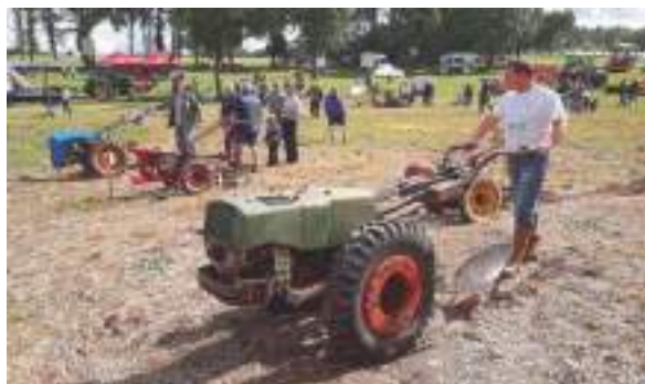
De LMP T4 was net nog ietsjes groter en met zijn 12 of 14 pk een niet te onderschatten machine. De T4 was het paradepaard van LMP.
