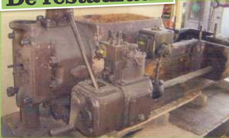
Solide basis: Voordat de restauratie begon, laste Ralf Funke een stabiel, in beton gegoten onderstel samen met het transportchassis
