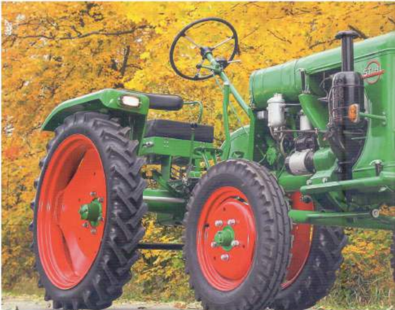
De Stihl-tractor S 140 is in de eerste plaats ontworpen voor kleine en parttime bedrijven. Door het lage gewicht en de daardoor minimale bodemverdichting ook zeer geschikt voor teelt- en onderhoudswerkzaamheden.
