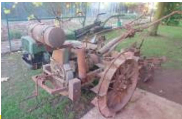
De eerste zware motoculteurs zoals de LMP T2 werden al gebouwd rond 1938, de LMP T4 uit 1946 is uitgerust met een viertaktmotor met een vermogen van 10 pk tot 12 pk.
