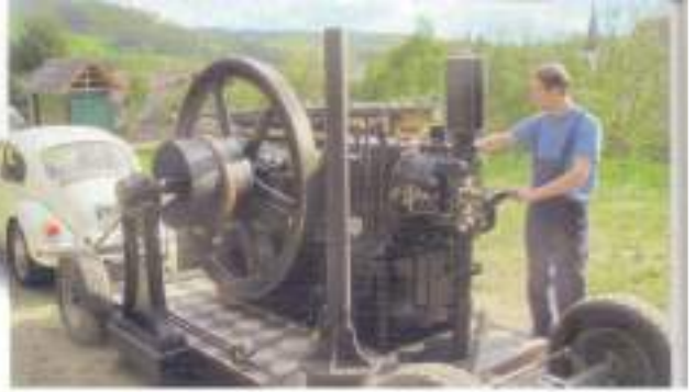
De trekkracht van de kever brengt het vliegwiel op snelheid. Nu decompenseur dicht, en boven in de emmergrote cilinder, verbrand het brandstof lucht mengsel.
