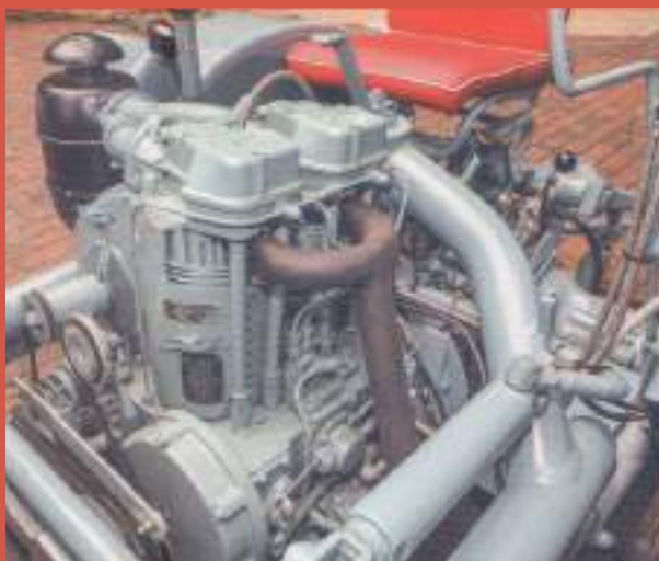
Zijn kenmerk, onderbroken koelribben. In 1961 was de EDK2a de eerste Eicher-diesel met gietijzeren cilinders in plaats van aluminium cilinders.
