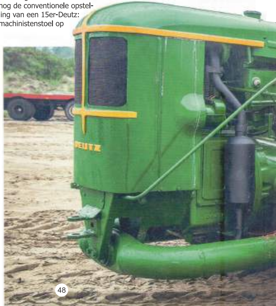
Met deze hendel schakelt de chauffeur van vooruit naar achteruit rijden. De achteruitversnelling is ideaal voor snel manoeuvreren.
