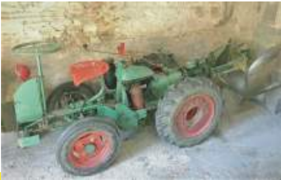
De 'Tractoculteur', had als basis de zware Labor P9. Met zijn vele beschikbare uitrustingsstukken was hij een ideaal voertuig voor de groentekwekers en wijnbouwers.
