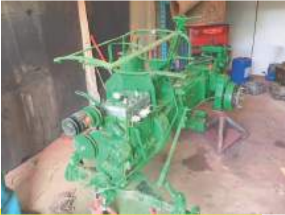
De LMP6 nadert zijn voltooiing na een grondige revisie. Nu moet de trekker ontvet, geschuurd, afgeplakt worden in afwachting van een eerste laag grondverf.
