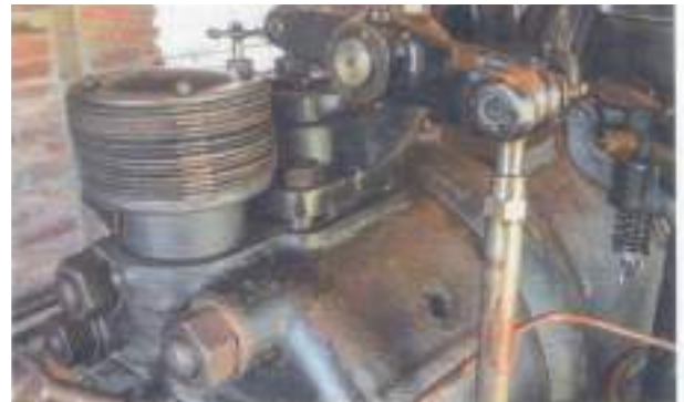
Het uitwasbare luchtfilter met metalen lamellen met bijna een onbeperkte duurzaamheid zit direct naast de nokkenas gestuurde inlaatklep.
