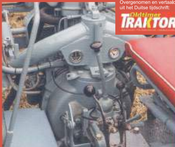
De versnellingen kunnen nog steeds niet makkelijk worden geschakeld, dus er is nog wat werk aan de winkel. Op de voorgrond de hendel voor de hefinrichting.
