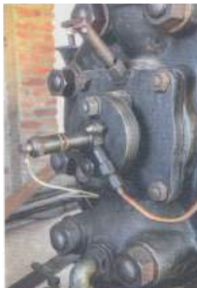
Een kleine naald in de injectieklep laat alleen brandstof vrij door de druk van de injectiepomp.
