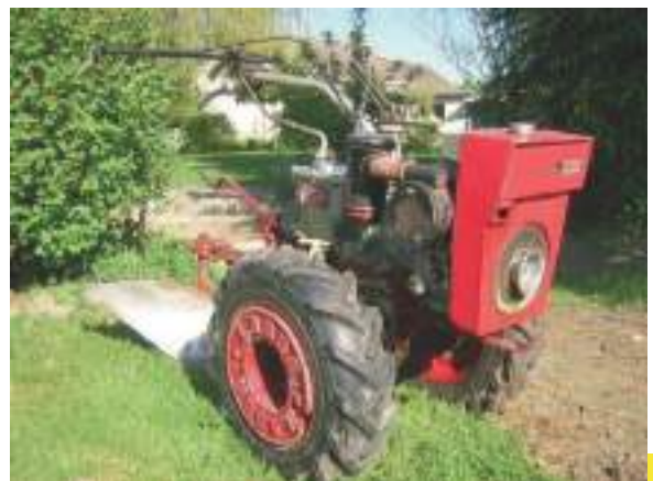
Labor 'Cadet', geïntroduceerd in 1964, was een verkoopsucces. De Cadet was zowel een motoculteur als motorschoffel. Het werktuig was verkrijgbaar met naar keuze een tweetakt- of viertaktmotor van Kohler, Bernard of JLO met een vermogen tussen 4 pk en 7 pk.
