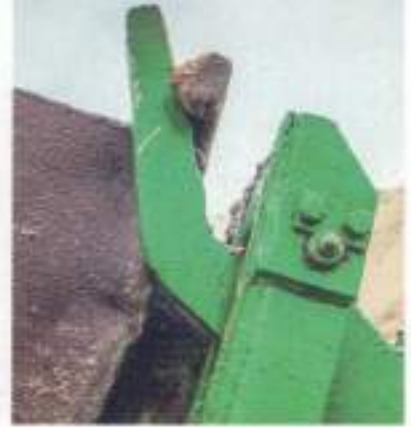
Slimme oplossing: de tanden zijn een vast onderdeel van het hefframe en schuiven automatisch uit zodra het frame omhoog komt.
