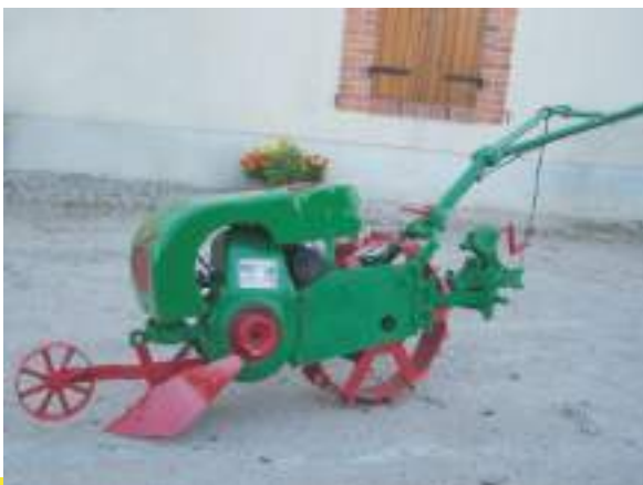
De motocultuur Monobi was verkrijgbaar in 2 uitvoeringen, het type L en het type LO. Het type L was met zijn 3 pk de lichtste uitvoering, de twee andere typen waren de LO5 (5 pk) en LO7 (7 pk). Op de foto de 1-wielige uitvoering.
