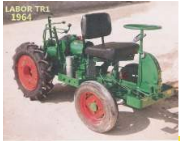
Van de Tractoculteur werden er verschillende uitvoeringen gebouwd, op de foto de TR1 uit 1964 met een tweetaktmotor van Hirth type D24.
