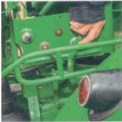
Met deze hendel schakelt de chauffeur van vooruit naar achteruit rijden. De achteruitversnelling is ideaal voor snel manoeuvreren.
