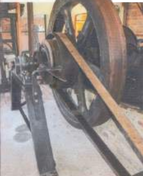
In de riemschijf is een koppeling geïntegreerd, waarvan de frictievoering bestaat uit kleine blokjes hout.
