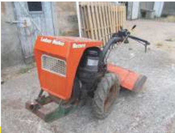
Een Labor Hako 'Record'. Deze motoculteur werd vanaf 1959 gebouwd bij Hako in Duitsland. De eerste versie was uitgerust met een ILO 2-takt motor met 6 pk. Latere versies waren uitgerust met o.a. een Lombardini 510 Ida Diesel. De 'Record' motoculteur werd alleen in Frankrijk met de merknaam Labor Hako verkocht.
