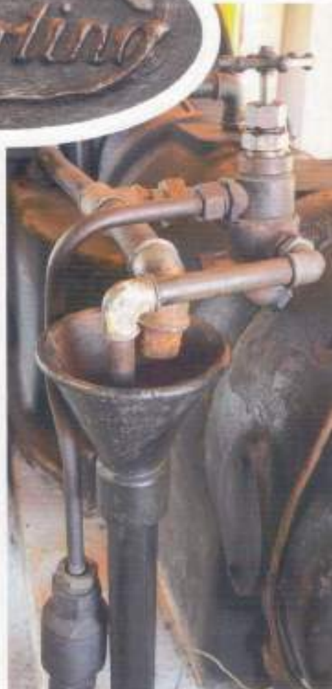
Met het regelventiel kun je een persluchtflus vullen met de restsnelheid wanneer de veldspuit is uitgeschakeld - voor het volgende opstartproces
