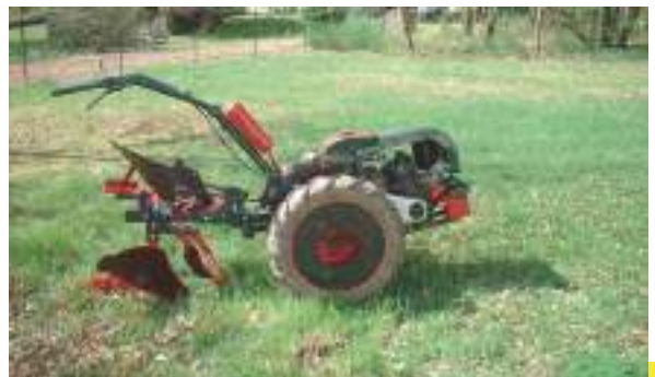
De populaire Monobi motoculteurs waren alle drie uitgerust met een eencilinder tweetaktmotor maar het bijzondere was dat ze snel van 1-wielige naar tweewielige motocultuur konden omgevormd worden.
