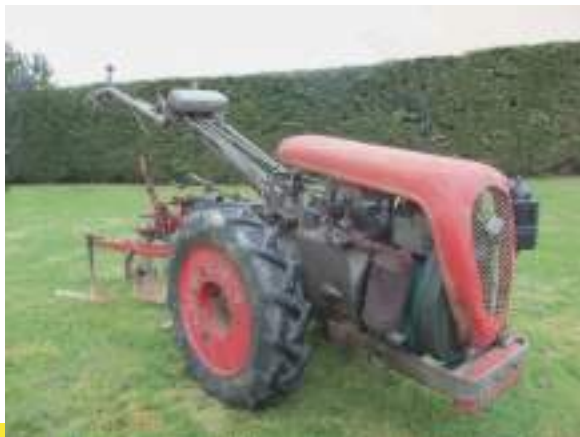
In 1962 werd de P20 geïntroduceerd. Deze zware motoculteur (om en nabij de 400 kg) was verkrijgbaar in benzine-of dieselluitvoering, met een Lombardini 85 viertakt benzinemotor met een inhoud van 498 cm 3 en een vermogen van 8-10 pk of een viertakt Berning dieselmotor van 9-12 pk.
