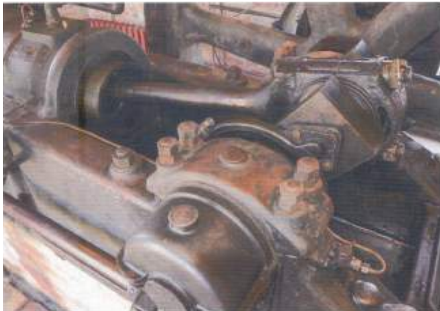
Glijlagers houden de kruk draaiend, de cilinder wordt gesmeerd via de koperen leiding. De lagerblokken zijn op een tiende afgesteld - het krukmechanisme draait daarom licht.
