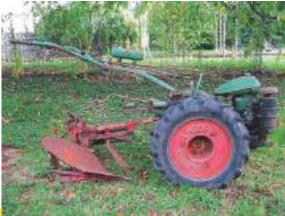
De Labor P9 werd in 1959 geïntroduceerd, hij was naar keuze uitgerust met een Labor benzine- of dieselmotor van 9 en 10 pk. Voor de P9 was er een ombouwkit beschikbaar zodat hij kon omgebouwd worden tot 'Tractoculteur'.
