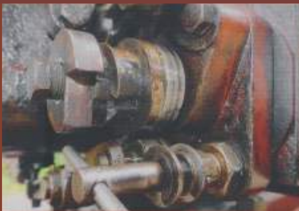
Starthulp: de beweegbare nok tilt de uitlaatklep op, na vijf krukromwentelingen komt de "bedieningsnok" in actie.
