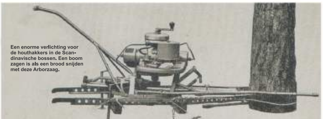
De tandzijn bedoeld om een stevige verbinding tussen de zaag en de boomstam te verzekeren. Dit werkt heel goed met de draadstrop.
