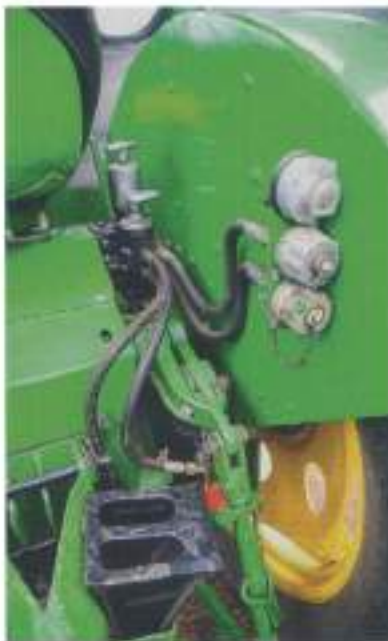
De hefhydrauliek, die met slechts twee hendels vanaf de bestuurdersstoel kan worden bediend, was een van de grote voordelen van Famulus.
