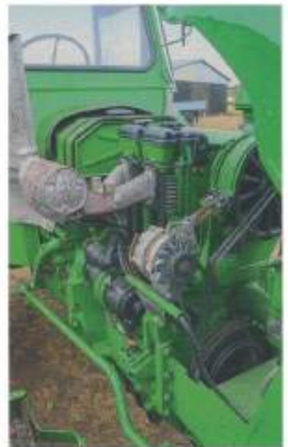
Dankzij luchtkoeling met behulp van een axiaalventilator kon de motor in de winter nooit bevriezen. Dat was ook een reden voor zijn populariteit.
