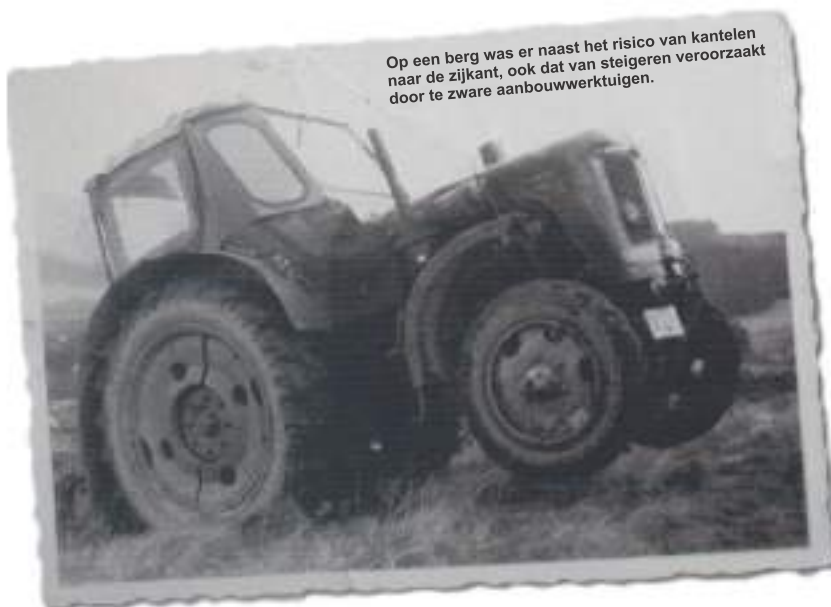
Ondanks het hogere vermogen van 36 pk haalde de watergekoelde Famulus 36 de verkoopcijfers van de luchtgekoelde variant niet.
