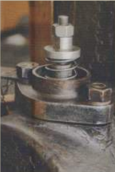
De snuffel-inlaatklep regelt de toevoer van het aan te zuigen brandstof-luchtmengsel onafhankelijk, d.w.z. onafhankelijk van de aansturing.
