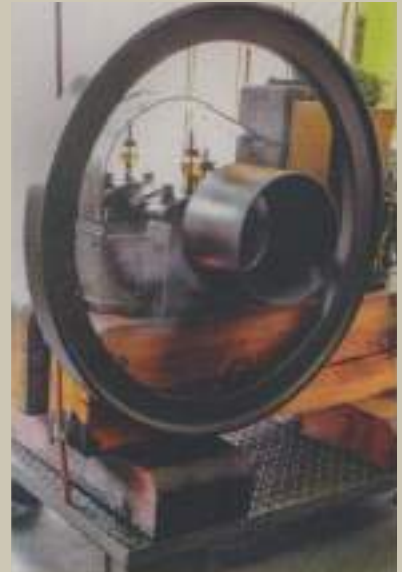
Bij "vol gas" komt de oude stationaire motor goed op gang. Het vermogen is ongeveer vier pk bij een toerental van ongeveer 300 tot 400 omw/min.
