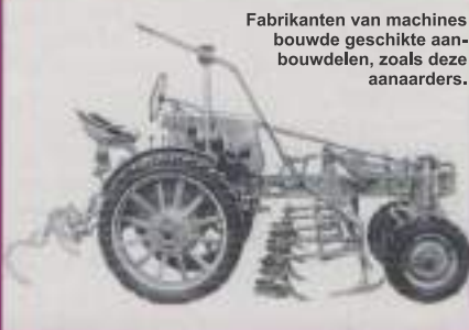
Tussen- en achteraanbouw hier de werktuigdrager met standaarduitrusting.
