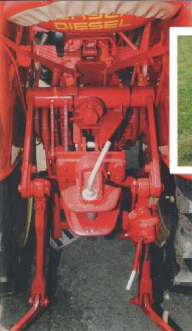
Wijnbouwers monteren graag een kabellier op het hydraulisch systeem. Met frontgewicht en tijdens de testen "weerstand" Junior alle belastingen.
