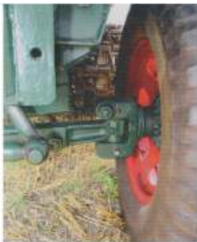
De voorste pendelas van de tractor: Kenners zullen hem associëren met de as van de F2 M417, die ook door Magirus in Ulm werd gebouwd.
