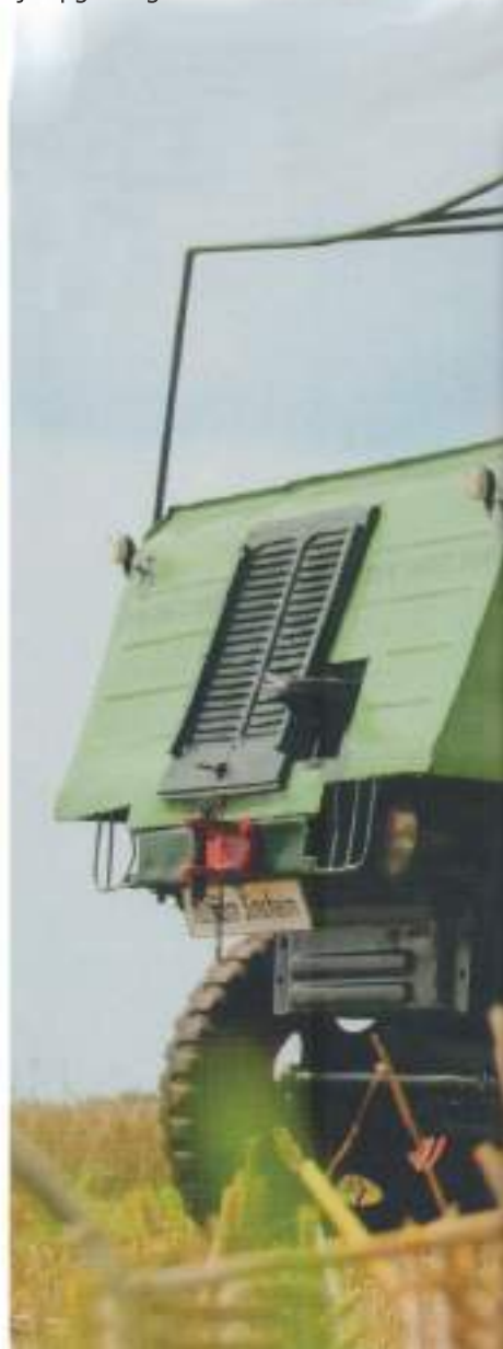
De achterkant van de RS1500 is volledig op zichzelf staand - met een reservewiel, katrol en onderste kaapstander als vervanging van de lier.
