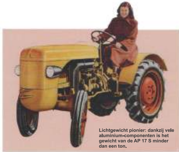
De lichtgewicht éencilinder is ver naar voren geplaatst, en draagt zo bij aan het gunstige zwaartepunt. De cilinderinhoud van slechts 822 cc was aanvankelijk voldoende voor een indrukwekkende 14 pk bij 2250 tpm.
