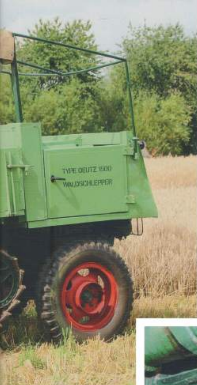
Dit is de RSO in zijn later vereenvoudigde versie met de vierkante, open cabine. Je kunt hierin de bostrekker al zien.
