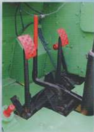
Bostractor's pedalen: de parkeerremhendel is aangepast aan de koppeling van de voormalige RSO-stuurremmen.
