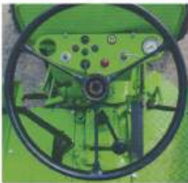
Het contactslot bevindt zich links, de gloeischakelaar bevindt zich aan de rechterkant en de zwarte schakelaar bedient de richtingaanwijzers.
