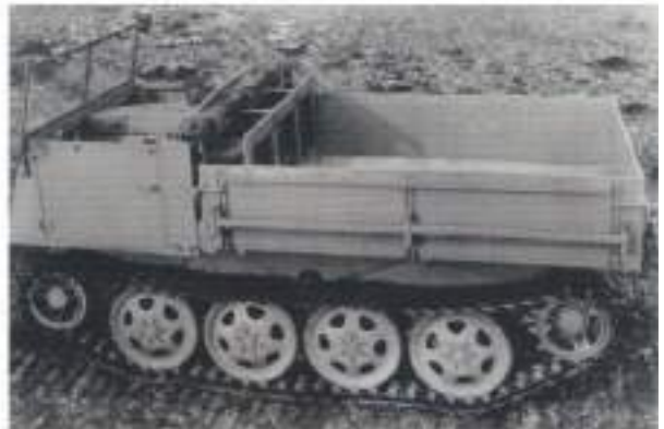
Dit is de RSO in zijn later vereenvoudigde versie met de vierkante, open cabine. Je kunt hierin de bostrekker al zien.
