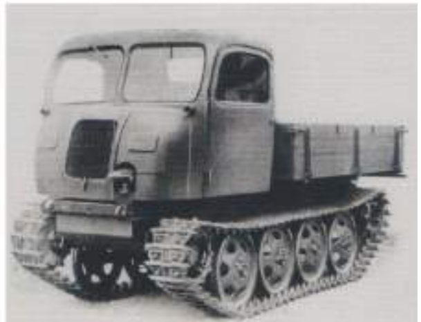
De volledig stalen cabine is met enkele kleine wijzigingen, afkomstig van de Steyr 1500 truck.
