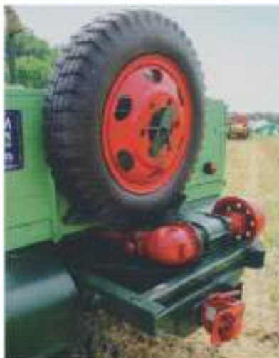
De achterkant van de RS1500 is volledig op zichzelf staand - met een reservewiel, katrol en onderste kaapstander als vervanging van de lier.
