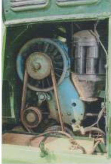
De Deutz F4 L514 op zijn eerste echte werkterrein: hij is behoorlijk smal in de bosbouwtractor en let op het luchtfilter aan de rechterkant.
