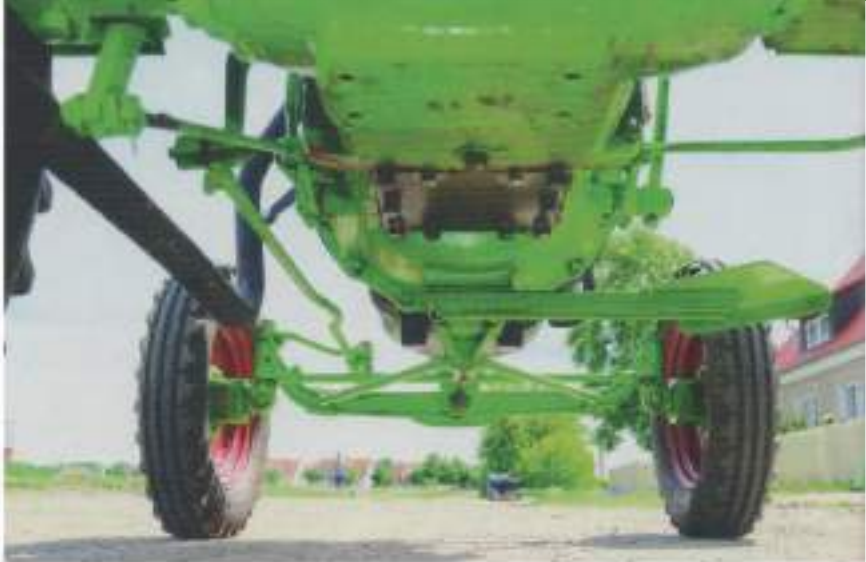
De voetremhendel zit rechts, de handremhendel links. Beiden werken via de remas in op de koppeling van de trommelrem. De vooras is pendelend geveerd opgehangen.
