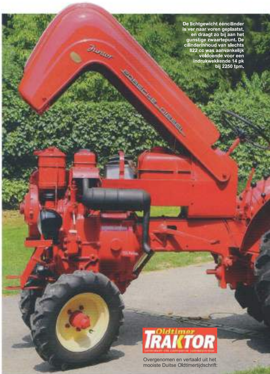
Lichtgewicht pionier: dankzij vele aluminium-componenten is het gewicht van de AP 17 S minder dan een ton.
