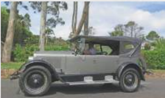
Een Velie uit 1924 model voor 1925 uitgerust met een 6 cilinder 28 pk motor en Warner transmissie 3 V. Het koetswerk is volledig uit aluminium maar toch weegt de auto 2,6 ton! Van dit model bestaan er wereldwijd nog 4 of 5 exemplaren.
