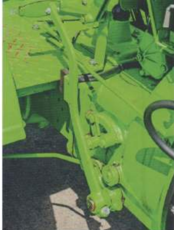
Voetrempedaal voor de trommelremmen op het achterwiel, het getande segment op de behuizing van de versnellingsbak wordt gebruikt om de hoogte van een aangebouwde maaier aan te passen.
