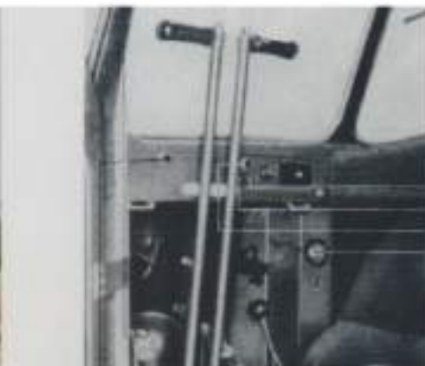
Ook de RSO-bedienshendels, gas- en koppelpedalen zijn herkenbaar. De hendel met de zwarte knop (midden) schakelt het sperddifferentieel.
