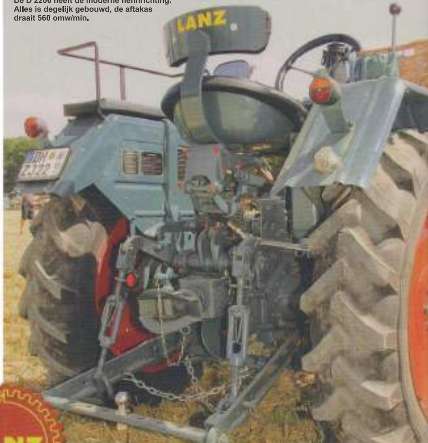
Voorkeur rechts: de asymmetrisch gemonteerde stuurkolom is het eerbetoon aan een directe en nauwkeurige stuurbediening, en ook goedkoper te produceren.
