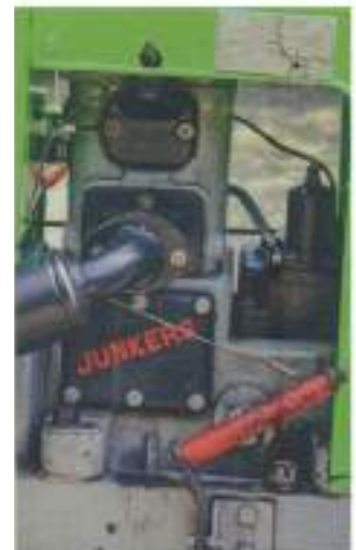
... de speciale smeercondities van de efficiënte Junkers-motor met tegengestelde zuigers. Het gat in de bovenkant van de kap is van granaatscherven.
