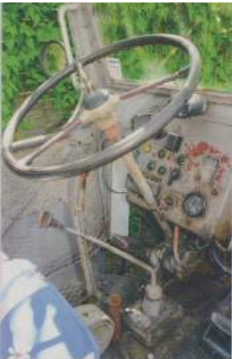
Voor een vooroorlogse trekker heeft de DA 20 een goed uitgerust instrumentenpaneel. Er wordt geschakeld volgens het klassieke H-schema.
