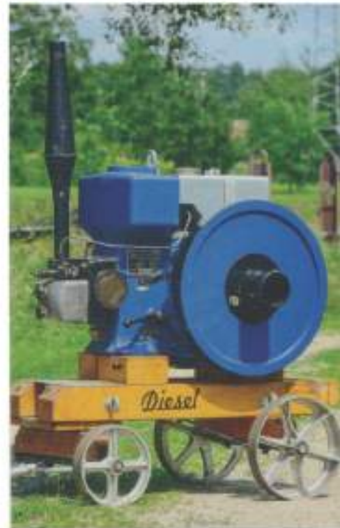
Universeel talent: De compacte verdamper diende als aandrijving voor pompen, generatoren, bouw-machines, vissersboten of dragline's.
