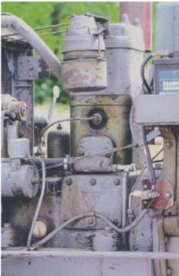
De tweetakt 1 HK 65 vertoont een goed startgedrag en bereikt een hoge mate van efficiëntie - mede dankzij waaivormige brandstofinjectie
