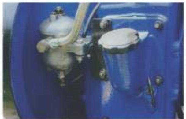
De H 65 is bijna volledig beschermt tegen vuil. De oliëvulopening, peilstok en brandstoffilter zijn desondanks van buitenaf goed bereikbaar
