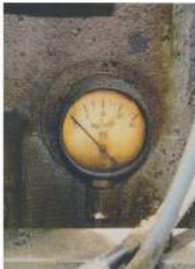
De manometer geeft de drukcondities in het carter weer. Het is vervaardigd volgens de DIN-norm, een teken van vroeger - TGL was de regel in de DDR.
