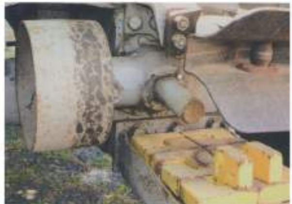
Poelie en aftakas krijgen hun impuls van dezelfde aandrijfas. De tractor is eenvoudig, maar biedt wel veel bruikbaarheid
