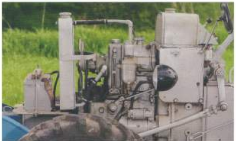
Tegenwoordig let de Stier bestuurder wat meer op de Hatz eencilinder tweetaktdieselmotor en voorkomt zo het vastlopen van de zuigers. Maar kan ook worden vermeden met een daarvoor speciaal geschikte olie.
