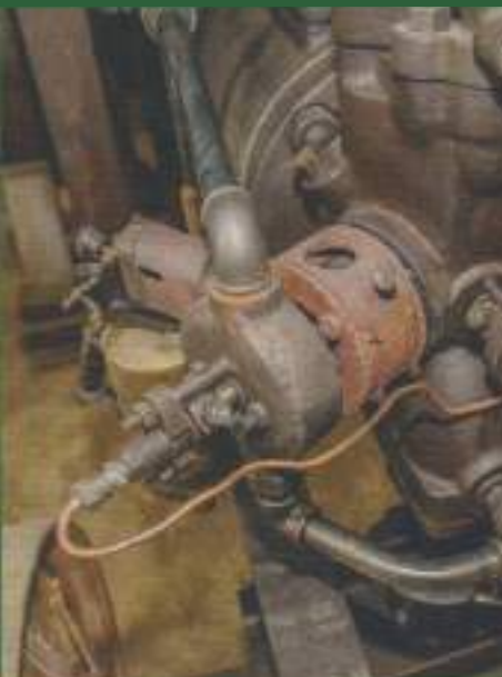
Deze Deutz-constructie geeft de MOR exotische status: Een watergekoelde verstuiver met daarachter een gloei-verbrandingskamer.
