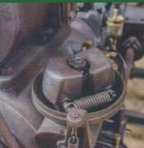
Ook dit onderdeel bezorgde Jakob Lindau hoofdpijn: de centrifugaal regelaar van het injectiesysteem, hier afgebeeld zonder beschermdeksel
