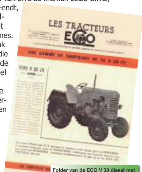
Folder van de ECO V 30 diesel met 30 pk. Hij was uitgerust met een 2-cilinder Cérés K 30 dieselmotor.
