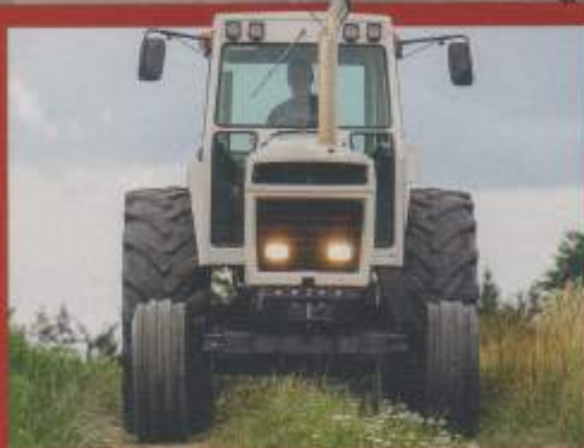
De cabine is smal, de Case 1370 heeft geen ruimte voor passagiers. En de dagen van de "row crop" versie, waar de tractoren eruit zien als driewielers, behoren ook tot het verleden.
