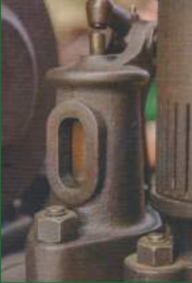
De behuizing en de tuimelaar van de inlaatklep lijken bijna een beeldhouwwerk, de filter loze luchtinlaatbehuizing wordt rechts weergegeven.
