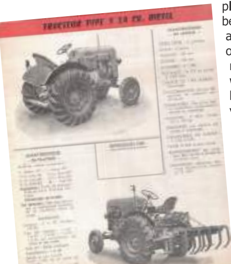
Folder van de ECO S 24 uitgerust met een Ceres viertakt 2-cilinder 2 liter motor met een vermogen van 24 pk.
