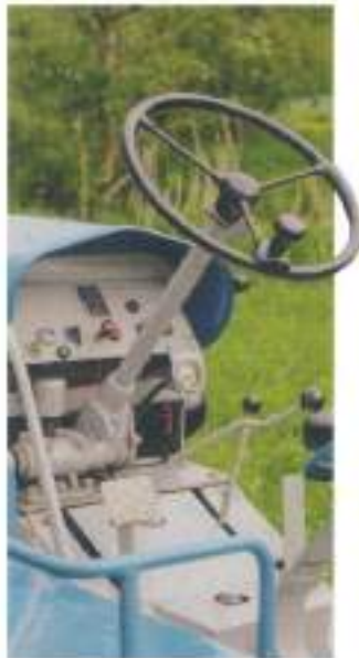
Het dashboard is uitgebreid met enkele instrumenten. Om met de Stier te rijden, is de stuurknop is een goede hulp bij het manoeuvreren.
