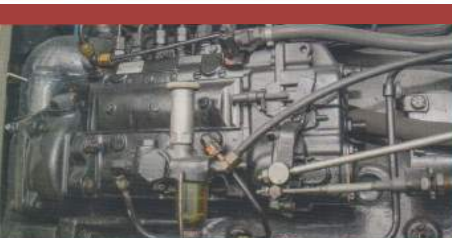
De klant is koning: Case gebruikte Bosch om de zes cilinders te voeden, alleen het injectiesysteem uit Duitsland is op verzoek van de Amerikanen voorzien van Inch aansluitingen.
