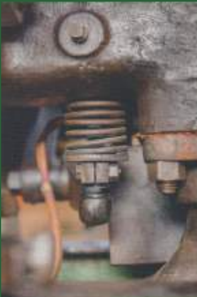
Aan de andere kant is de positief gestuurde uitlaatklep van de horizontale ioe-ruwoliemotor (ioe = Inlaat over uitlaat) puur functioneel.
