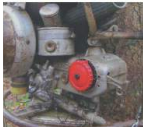
De klimhoogte wordt ingesteld met het rode wiel op de tandwielkast. Hierop zit ook de Simplex oliepompe voor de kettingolie.
