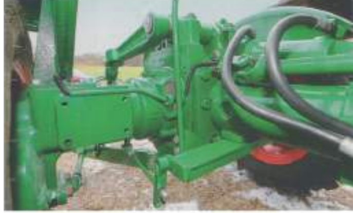
De gehele achterzijde draait op een centrale buis, waardoor de achterwielen altijd op de grond blijven. De cardanas rechts leidt naar de aftakas.
