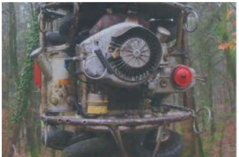
Na bevestiging aan de boom wordt de start uitgevoerd door aan de kabel te trekken. De kleine ééncilinder van Sachs beweegt tegelijkertijd de aandrijfwielen en de Prinz-landketting
