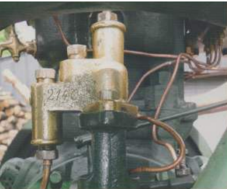
Weten hoe: Drie terugslagkleppen helpen de motor soepel te laten lopen. Jupp Drückes ontmaskerde de ontbrekende bal als belangrijkste reden voor het drukverlies.
