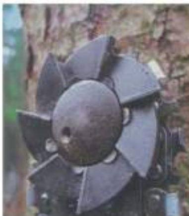
Aan het zwaard is een freeskop bevestigd waar de ketting met tanden omheen loopt, zodat de ketting niet zo snel klem komt te zitten.
