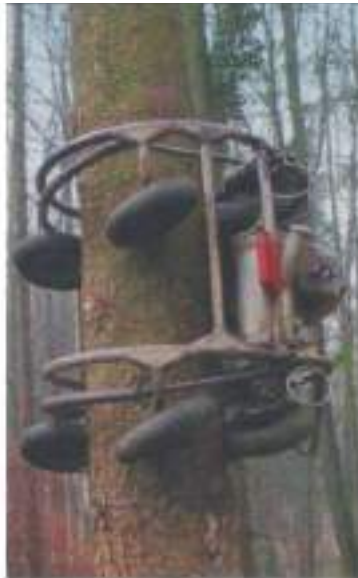
Een van de problemen van de klimzaag is de hoge druk op de schors, die de sapstroom kan verstoren.
