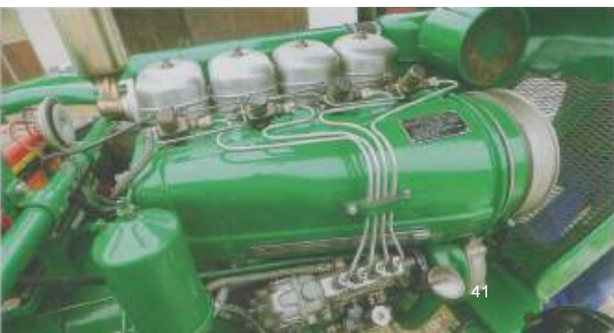
De F4L712 produceerde 13 pk per cilinder bij ongeveer 2300 omw/min. De 712 Deutz motoren onderscheiden zich van hun voorgangers uit de 612 serie, door een grotere boring: 95 in plaats van 90 mm voorheen.
