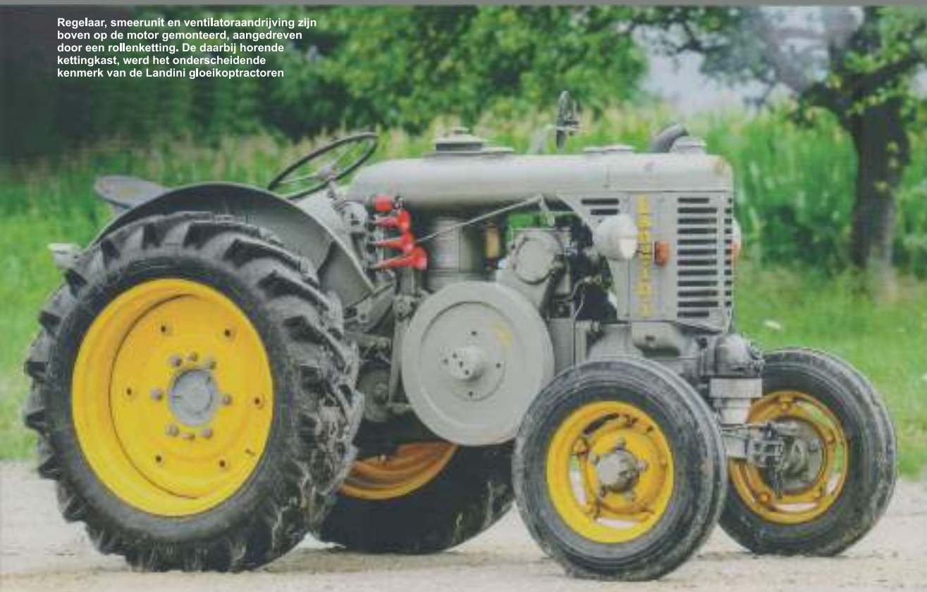
De grote buis, in het midden van de koeler, bevordert een betere natuurlijke koeling.
