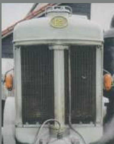
De grote buis, in het midden van de koeler, bevordert een betere natuurlijke koeling.
