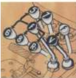
Het schakelschema in de Fiat handleiding: "F" staat voor stationair, "L" voor de lage versnellingen en "V" voor de normale versnellingen.
