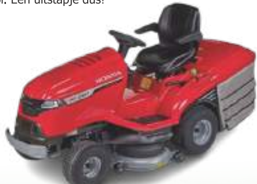
Dit is de Honda hoe hij nu is. De HF-2217 is een dure machine maar wel een goede machine. Zijn maaidek heeft de capaciteit om heel goed gras op te vangen doordat een 2 tal ventilatoren de messen helpen het gras naar de vangbak te blazen.
