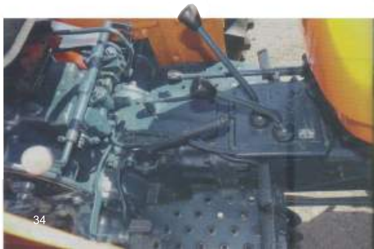
Het schakelschema in de Fiat handleiding: "F" staat voor stationair, "L" voor de lage versnellingen en "V" voor de normale versnellingen.
