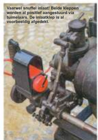
"Er zit een pin in de oliespuit die omhoog gaat als hij draait", zegt Walter Baumann over de smeermiddeltoevoer naar de binnenste lagers van de krukas. Voor de buitenste lagers zijn aparte oliereservoirs aanwezig.
