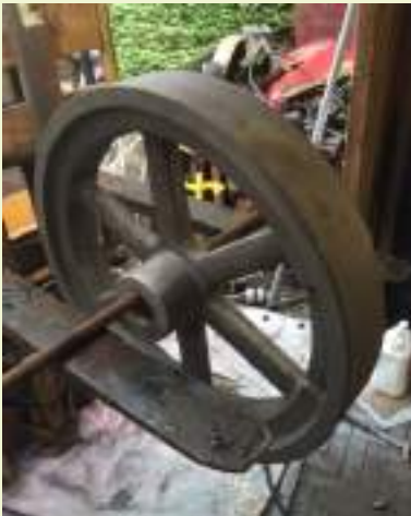
Gelukkig zaten de vliegwiel en ook de spieën daarvan niet zo vast en konden gemakkelijk gedemonteerd worden. Hier is hij zojuist gestraald en klaar om in de epoxy gezet te worden
