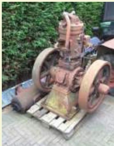
De motor zoals gevonden, nu thuis in Nueneen. De motor zit muurvast maar is grotendeels compleet voorzien van veel roest, gevormd in de afgelopen decennia.
