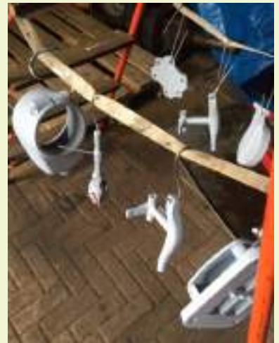
Diverse onderdelen zojuist in de epoxy gespoten. Je ziet hier ook de belangrijke reguleurgewichten van de motor.
