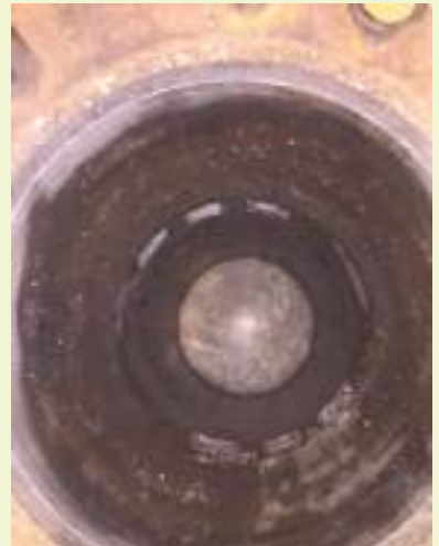
De cilinder van bovenaf gezien. Gelukkig was deze na schoonmaken en honen in goede staat. Gelukkig was de koelmantel niet kapot gefroren
