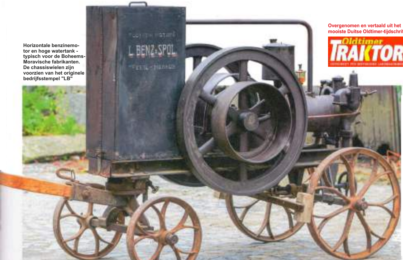
"Er zit een pin in de oliespuit die omhoog gaat als hij draait", zegt Walter Baumann over de smeermiddeltoevoer naar de binnenste lagers van de krukas. Voor de buitenste lagers zijn aparte oliereservoirs aanwezig.
