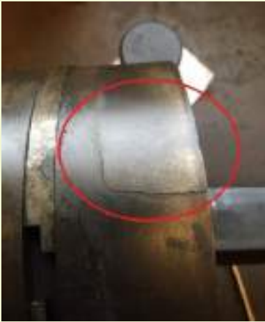
Een klein probleem is wel dat in een verleden de drijfstaaf vermoedelijk bij demontage door een monteur iets te hard tegen de zuigermantel is aan gekomen. Resultaat, een behoorlijk scheur!
