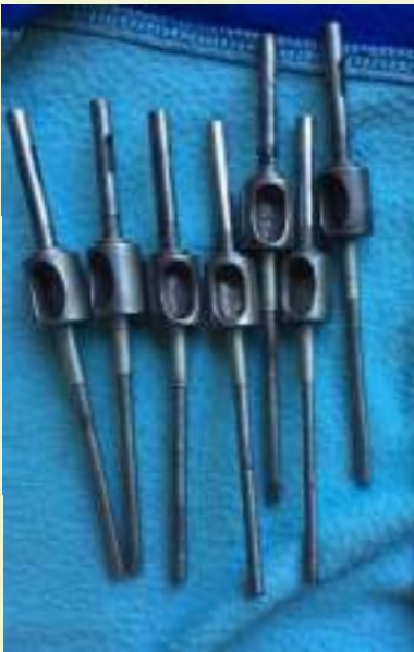
De pluniers die de olie oppompen naar de te smeren delen van de motor. Hier al zuiver gemaakt.
