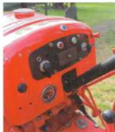
... terwijl de instrumenten van de jongere D180 H door de ontwerpers van Gottmadingen in de verlengde tankconsole werden geïntegreerd.
