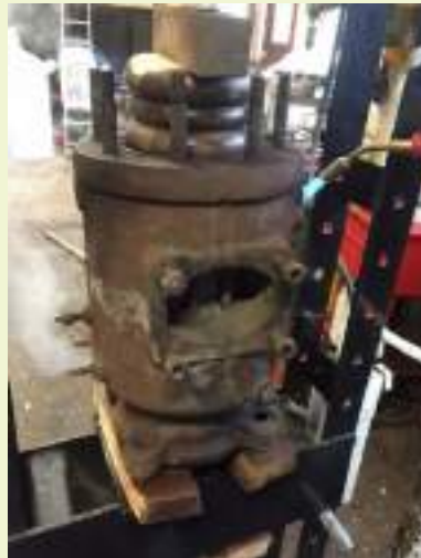
De cilinder met zuiger onder de hydrauliekpers. Op de zuiger (niet zichtbaar) licht een in vorm gemaakt hardhouten blok die er voor zorgt dat de kamzuiger niet beschadigd.
