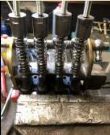
De smeerautomaat plungers en het lichaam waar ze in zitten alweer netjes en goed bevonden. De plungers bouwde gelukkig allemaal vacuüm en druk op.
