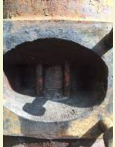
De zuiger in de cilinder vanaf de uitlaatkant gezien. De uitlaatpot (originele) is erbij, en stond tot boven de uitlaatpoort vol met regenwater.
