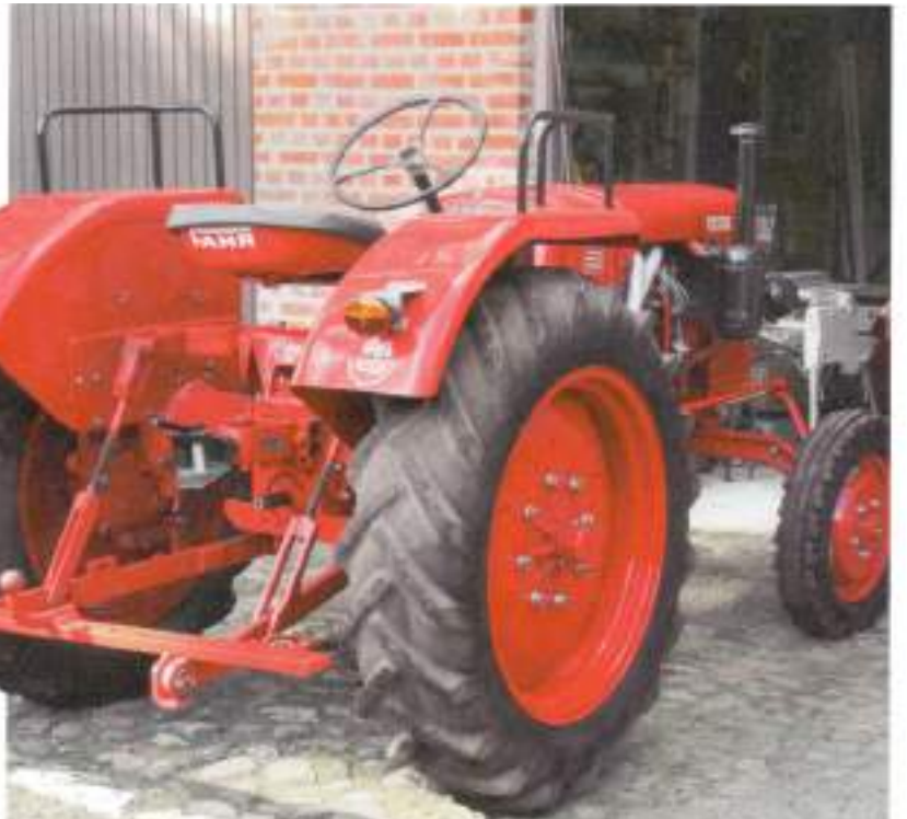
De hydraulische driepunts hefinrichting van de D180 H behoorde tot de optionele uitrusting en wordt aangedreven door een stabiele tweezuigerpomp voor drukken tot 200 bar
