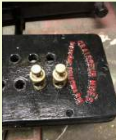
De bovenkant (deksel) van het smeerautomaat in de verf en al voorzien van een paar stelschroeven voor de plunjerverplaatsing te verstellen. (oliehoeveelheid regeling)
