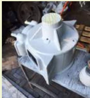
Het carter van de motor in de epoxyprimer. Lagertjes van de motor vertoonden gelukkig weinig tot geen speling en waren netjes. Alsook de kruk was netjes en glad.
