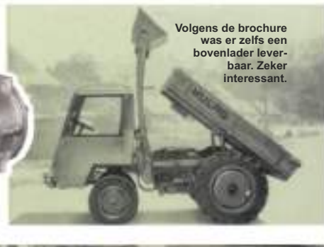
Dankzij de aandrijfeenheid herkende men de tractor. Dankzij de portaalassen kan de wielbasis met een klein beetje schroeven worden verlengd.
