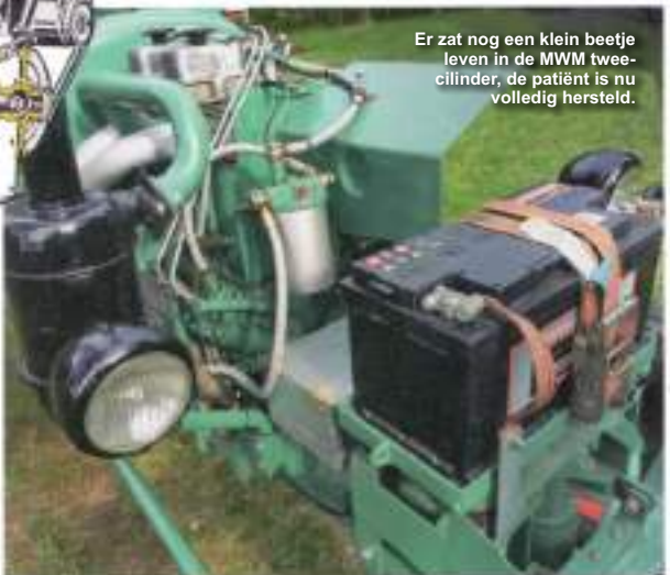
Voeringen en zuigers, keerringen en lagers... niets bleef onaangevoerd tijdens de motorrevisie.
