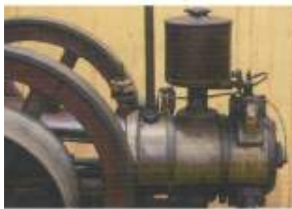
De zwaartekracht zorgt voor benzine, en de snuffelklep in de vlotterloze carburateur regelt de toevoer van het brandstofmengsel naar de verbrandingskamer.
