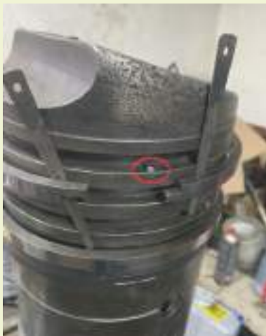
De zuigerveren worden gemonteerd op de zuiger. Een zuigerveertang in deze maat heb ik niet, dus een paar oude voelermaten deden hun werk als geleider prima! Bij de rode cirkel is het pinnetje te zien waar het zuigerveerslot omheen valt.
