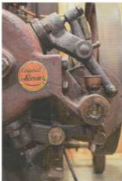
De inlaat- en uitlaatkleppen steken diagonaal vanaf "stuurboordzijde" de cilinder in. Een vetpot voorziet het eindlager van de tussenas permanent van smeermiddel.
