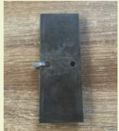
De oude membraan platen die vervangen werden door carbon platen. Het werkt perfect!
