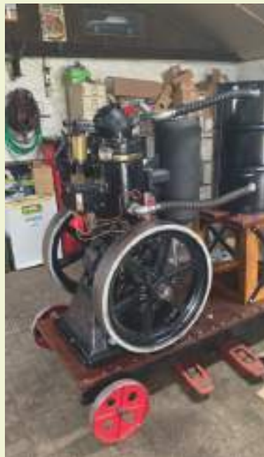
De motor nu in zijn geheel met het koelvat en de tafel op zijn plaats.
