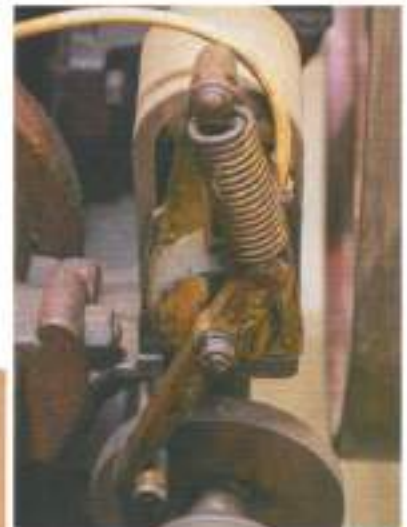
Het anker van de ontstekingsmagneet ontvangt een korte draai-impuls van de stuuras, wat voldoende is voor een hoogspanningsvonk.
