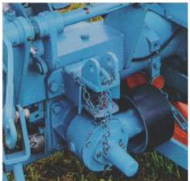
Als optie was de aanbouwriemschijf met schuine aandrijving leverbaar. Hiervoor werd de aftakas verlengd en de afbuiging ertussen gemonteerd.
