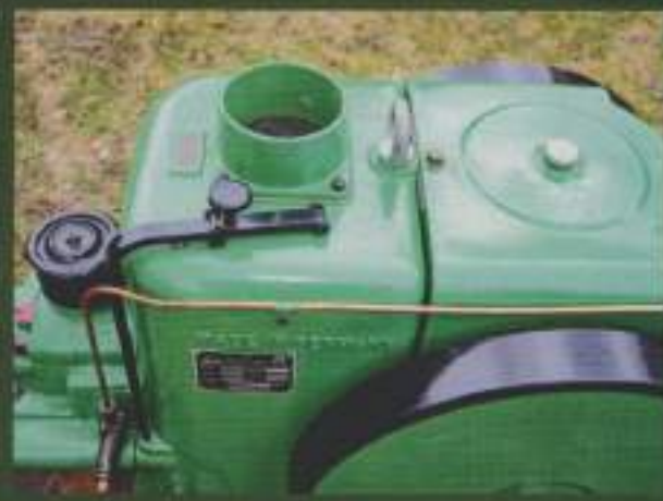
Met de handdrukknop wordt het decompressieventiel geactiveerd. Voor een beter startgedrag bij koud weer, warm water bijvullen.
