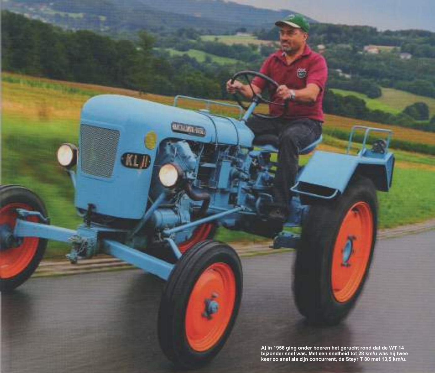
Grote bodemvrijheid en een laag gewicht maakten de WT 14 tot een voorbeeld bijzonder interessant voor onderhoudswerkzaamheden en groenteteelt.
