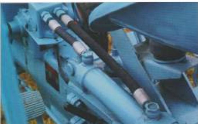
Bij de hydrauliek van Bosch kon de cilinder heffen en duwen.
