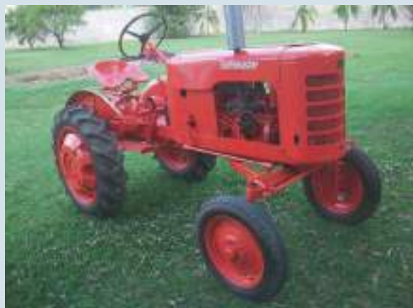
De Earthmaster D tractor uit 1948 was uitgerust met een Continental 4-cilinder motor en had 9 versnellingen vooruit dankzij zijn 3 overbrengingsverhoudingen en 3 gashendel instellingen.
