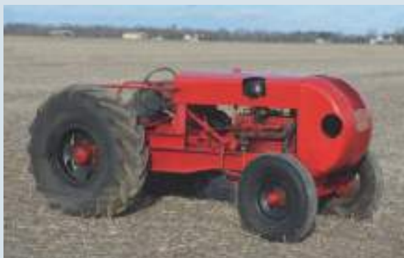
De Friday 0-48 trekker werd aangedreven door een 6-cilinder Chrysler benzinemotor met een vermogen 50 pk. De transmissie had 5x2 versnellingen vooruit en 2 achteruit.
