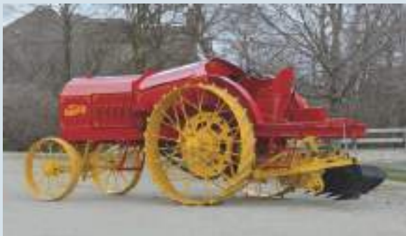
De hef wordt door de bestuurder bediend vanaf de trekkerstoel, vooruitstrevend voor die tijd.
