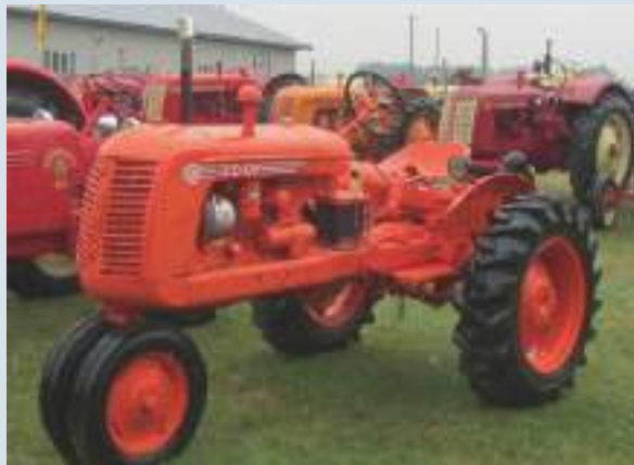
De CO-OP model E2 is identiek aan de Cockshutt 20. De motor was een 4-cilinder 2 l. Continental met een vermogen van 30 pk. Hij werd gebouwd in Brantford, Ontario tussen 1952-53.
