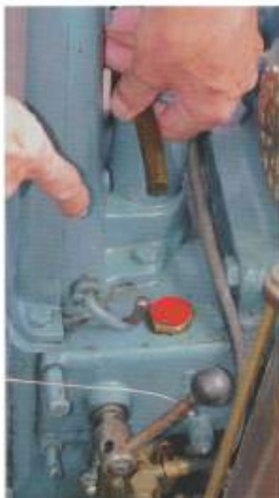
Service truc: trek de slang los en houd deze in een bak, start dan de motor en laat hem stationair draaien. Na het verdraaien van de hendel wordt de olie eruit gepompt. Er blijft een restant in het carter achter dat voor smering zorgt.
