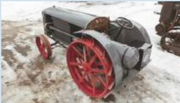
De trekker verbrandde kerosine om stoom op te wekken, de brandstoftank had een inhoud van 132 liter en het waterreservoir 227 liter.
