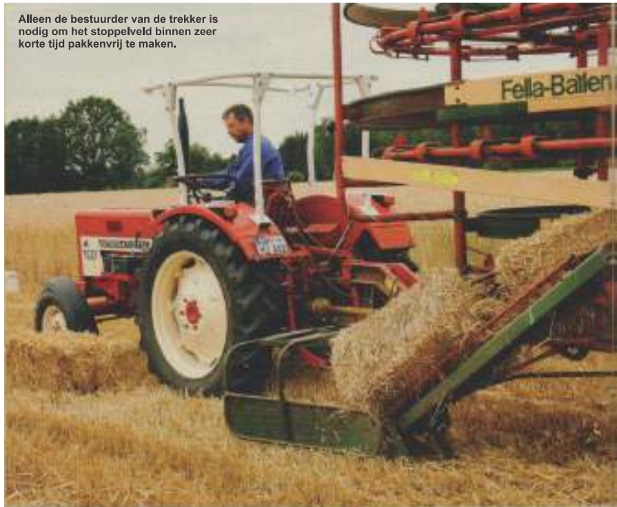
Als de uit de ontvangst-inrichting geduwde baal tegen dit vouwmechanisme drukt, komt de carousel langzaam op snelheid.
