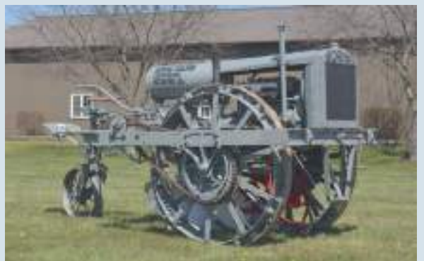
De Boring 12-25 uit 1920 was een combinatie van een trekker, cultivator en motorploeg. Alle werktuigen werden onder de machine bevestigd. De tractor werd aangedreven dooreen viercilinder Waukesha-motor.
