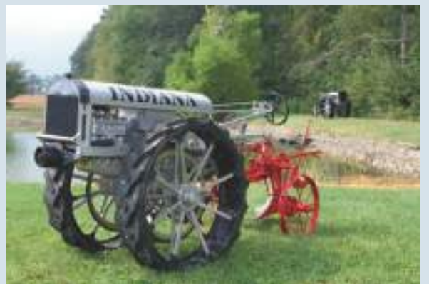
De Indiana trekker werd in 1919 geïntroduceerd, hij was uitgerust met een LeRoï viercilindermotor.
