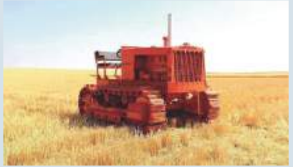
Na W.O. 1 bleef Monarch rupstrekkers maken waaronder het Model 50 waarmee Monarch behoorlijk succes kende. De Model 50 werd aangedreven door een 9,2 liter Stearns 4-cilinder benzine motor met een vermogen van 50 pk en werd gebouwd van 1926 tot 1931.
