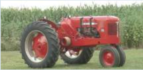
De Custom 98, gebouwd van 1952 tot 1954 had een Dodge Gyrol Fluid Drive transmissie met 5 versnellingen vooruit en 1 versnelling achteruit. De motor had een vermogen van 55 pk.
