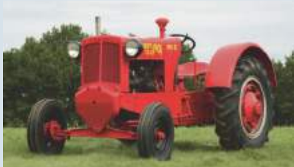
De CO-OP N° 2 werd ook gebouwd door Duplex Machinery Co. De trekker had een Chrysler zescilindermotor met een vermogen van 36 pk.
