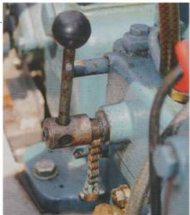
Service truc: trek de slang los en houd deze in een bak, start dan de motor en laat hem stationair draaien. Na het verdraaien van de hendel wordt de olie eruit gepompt. Er blijft een restant in het carter achter dat voor smering zorgt.
