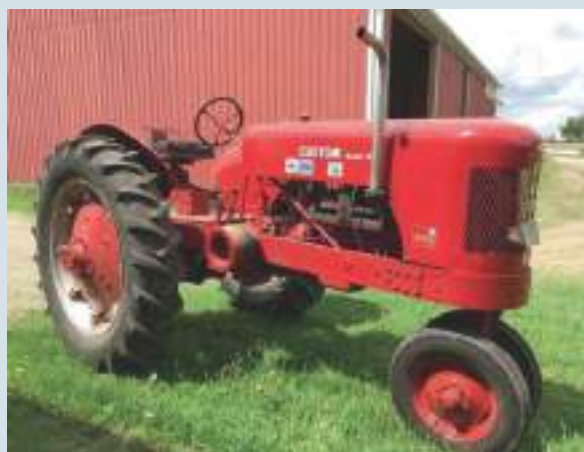
De Custom B row-crop trekker werd gebouwd van 1947 tot 1949. Hij had dezelfde motor en transmissie als de Model C.
