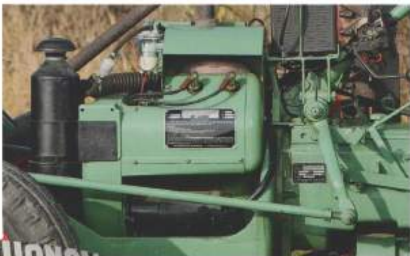
Zijaanzicht van de luchtgekoelde viercilindermotor in V-opstelling. De elektrische benzinepomp (links) is achteraf gemonteerd - normaal doet een mechanische membraanpomp hier zijn werk.
