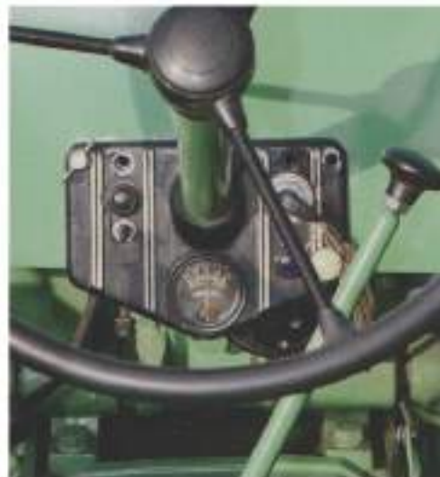
Het dashboard is tot een minimum beperkt - typisch voor de jaren vijftig - en biedt slechts één meter aan de onderkant: een ampèremeter.
