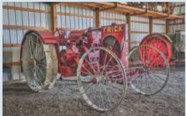
Het tweede type was de 15-28, die was uitgerust met een dwarsgeplaatste 4-cil. Beaver benzinemotor. Deze 15-28 had een gewicht van 2766 kg.
