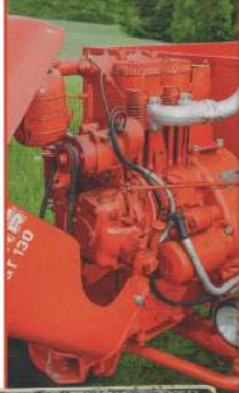
De tweecilinder 2 LD uit Aschaffenburg. De 17 pk waren geenszins voldoende voor de werktuigdrager.
