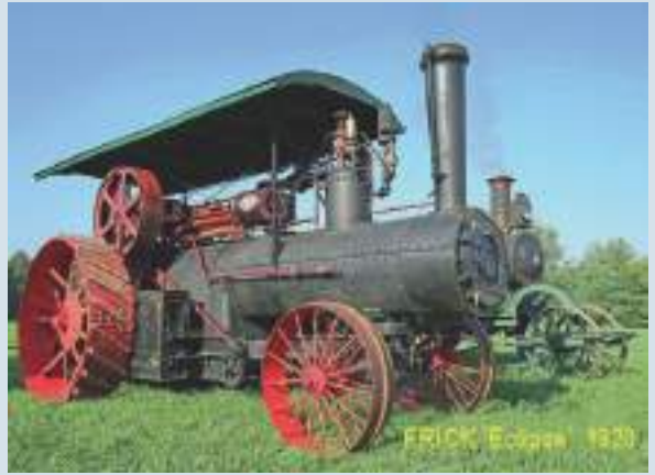
De Eclipse on Wheels was de eerste stoommachine van Frick Co. in 1874. De stoommachine werd gebruikt voor het dorsen van graan, het 'egreneren' van katoen (scheiden van zaden en vezels), het aandrijven van zaagbanken maar ook voor transport. De productie van stoommachines eindigde in 1945!
