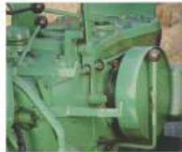
Dit is niet de riemschijf, maar een van de twee externe hydraulische trommelremmen.
