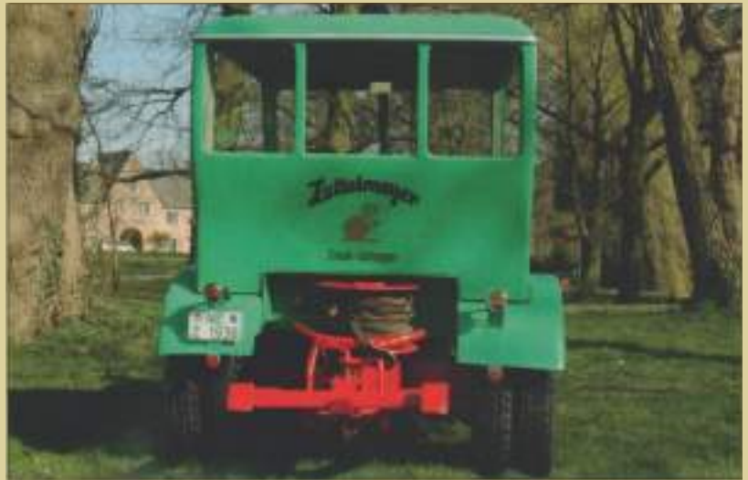
100 meter kabel; De lier was vanaf fabriek leverbaar als een extra uitrusting.
