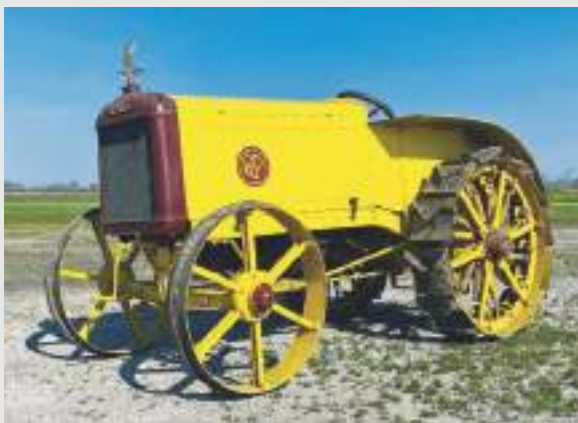
De Republic Truck Company bouwde de R & P 12-20 landbouwtrekker. Hij werd aangedreven door een Waukesha 4-cilinder motor Model B en had een nominaal vermogen van 12 pk aan de trekhaak en 20 pk aan de riemschijf.
