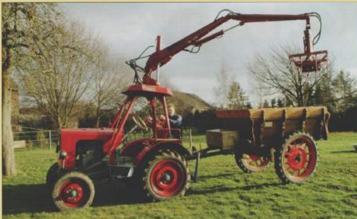
Kantelbaar: Het hoge zwaartepunt van de kraan boven op de delicate Zettelmeyer, kan voor lastige situaties zorgen als de grijper beladen is.
