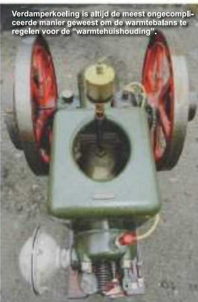
Via individuele smering worden alle bewegende delen voorzien van de benodigde olie.
