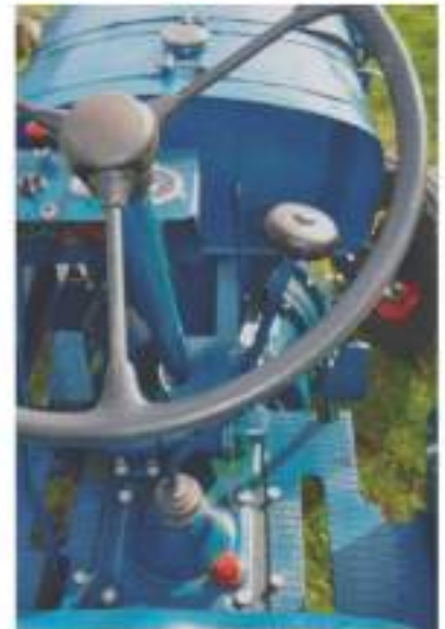
Netjes verdeeld: de spaarzaam toegewezen instrumenten bevonden zich links van het stuur,- en de versnellingspook rechts.
