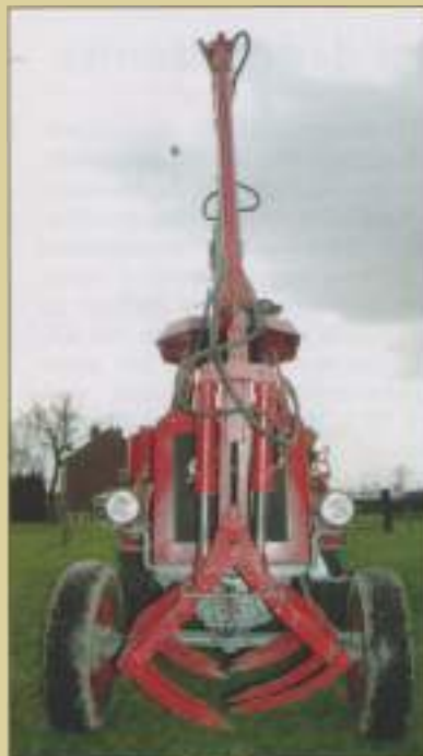
Zeldzaam voorwerp: vanwege ruimtegebrek moet de grijper van de Wehrhahn-lader vóór de Zettelmeyer-kap worden vergrendeld.
