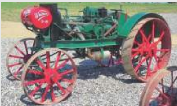
De Whitney 9-18 woog ongeveer 1360 kg, had een wielbasis van 2,08 mtr en een totale lengte van 3,12 mtr. De ronde brandstoftank was op beugels voor de radiator gemonteerd. De Whitney 9-18 bleef in productie tot 1921.
