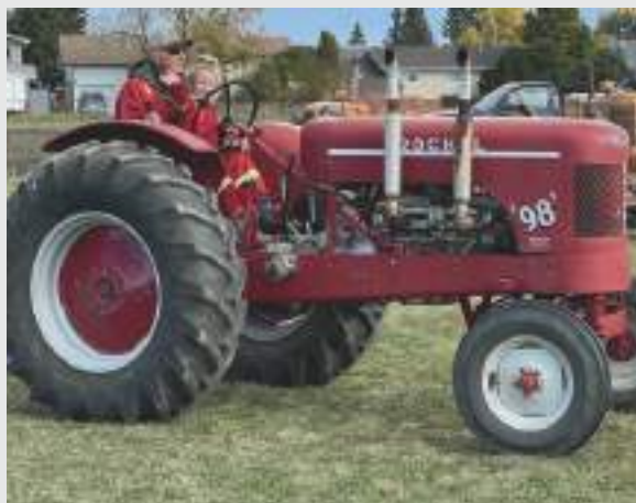
Rockol FD 98 met een Chrysler L-head, 6-cilindermotor, Gyrol Fluid Drive vloeistofkoppeling en 5 versnellingen. Er werden er 2.000 van gebouwd.
