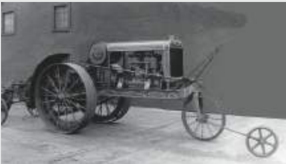
In 1917 werd de trekker vervangen door model 12-25 die uitgerust was met een Climax viercilindermotor met volledige druksmering. In 1919 werd die vervangen door de J 12-25 een bijna identieke trekker maar met 'echte' radiator, een volledige motorkap en gesloten motorcompartiment. Het meest opvallend waren de 4 wielen.
