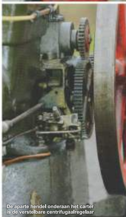
Veel functionaliteit in een kleine ruimte. Interessant is de opstelling van de kleppen in relatie tot de posities van de carburateur en het uitlaatkanaal
