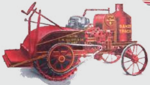
G. W. Elliott bouwde in 1911 "Dakota"-tractoren in een omgebouwde veestal. De Dakota trekkers hadden een groot breed achterwiel met op de as een tandwiel voor de kettingaandrijving en twee kleinere voorwielen. Ze waren uitgerust met Waukesha motoren.
