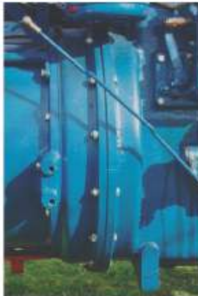
Verbinding: Tussen de Renk versnellingsbak en de MWM motor moest een pasring gemaakt worden, bij een Deutz motor was dit niet nodig.
