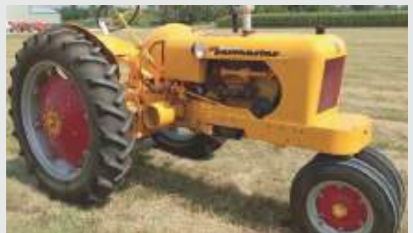
De Farmaster is een zeldzame tractor geproduceerd in Clifton vanaf 1948 door Farmaster Corporation. Er waren twee typen, de Farmaster FG-33 met een Buda viercilinder kerosinemotor en de dieselvversie Farmaster FD-33 met eveneens een Buda motor.
