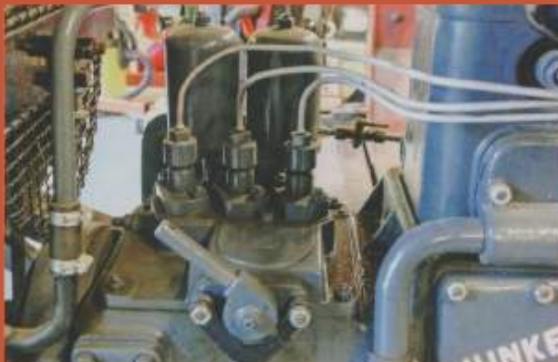
De Junkers driezuiger injectiepomp komt uit eigen productie. Met de kleine instelhendel kan het toerental van de tweetaktdiesel met tegenzuiger fijn worden geregeld.
