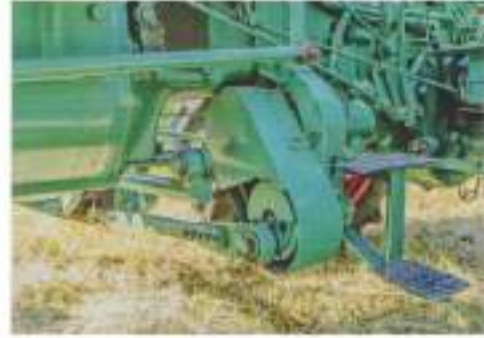
De maaier wordt aangedreven via een directe tandwieloverbrenging en is voor het geval dat hij vastloopt, voorzien van een slipkoppeling
