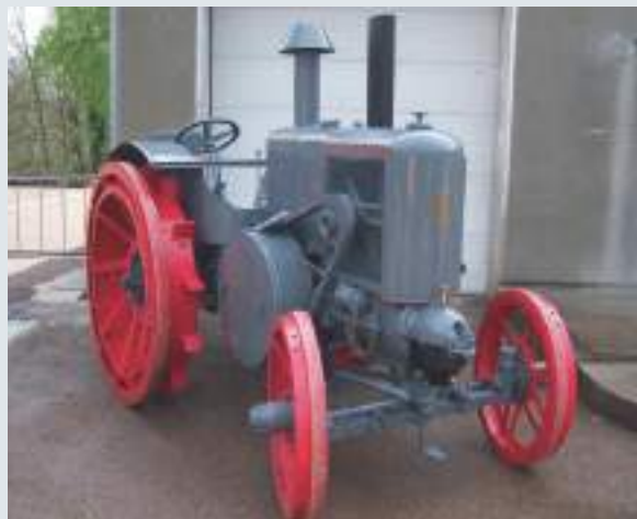
De H1 was de eerste door SFV gebouwde trekker. Hij had een cilinderinhoud van 10.340 ccm 3 en een vermogen van 22-38 pk. De serieproductie begon in 1934 en liep door tot 1941.
