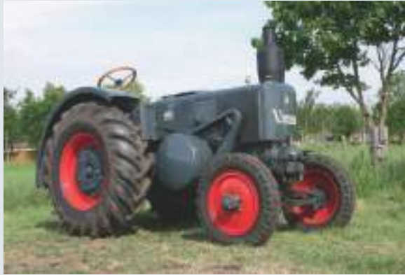
De Vierzon 401 werd gebouwd van 1950 tot 1952, heeft een vermogen van 45 pk en een transmissie met 5 versnellingen vooruit en 1 achteruit.
