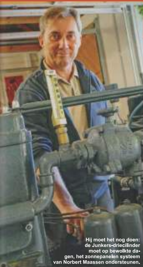
De Junkers driezuiger injectiepomp komt uit eigen productie. Met de kleine instelhendel kan het toerental van de tweetaktdiesel met tegenzuiger fijn worden geregeld.
