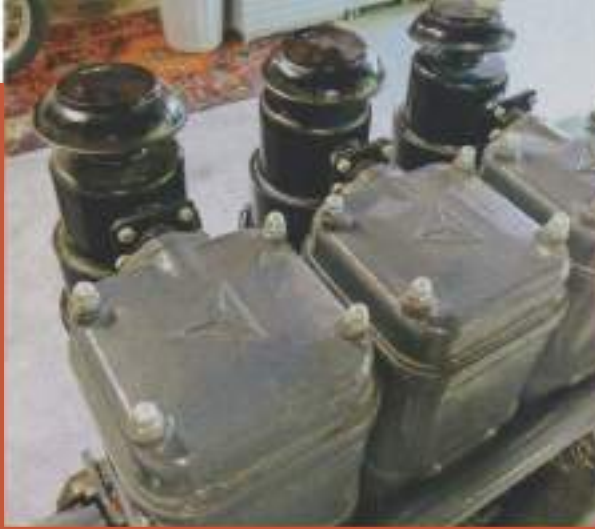
Onder deze deksels bevinden zich de spoelpompen met de drie membraansnuffelkleppen. Het vervangt eigenlijk de voordruk vanuit het carter.
