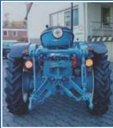
Ongeval: Tijdens de restauratie kwam de hummel op de aftakas terecht, en die moest daarom gericht worden.
