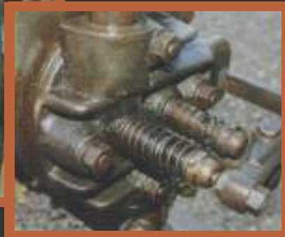
De inlaatklep zuigt het mengsel aan met onderdruk, alleen de uitlaatklep wordt geregeld.
