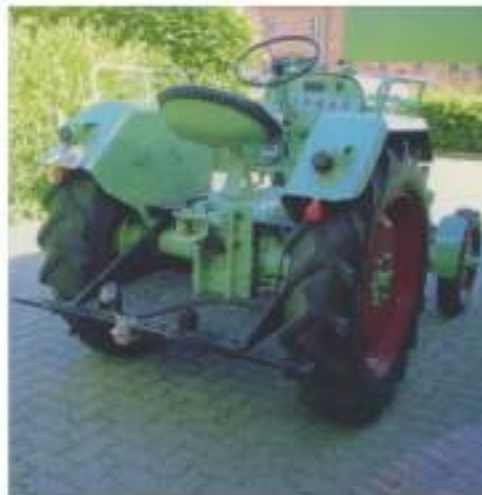
Hulp uit het buurland: De Nederlander Karel Kersjes heeft de achterspatborden opnieuw opgebouwd - en ook Frohbös z'n tractor er van voorzien.
