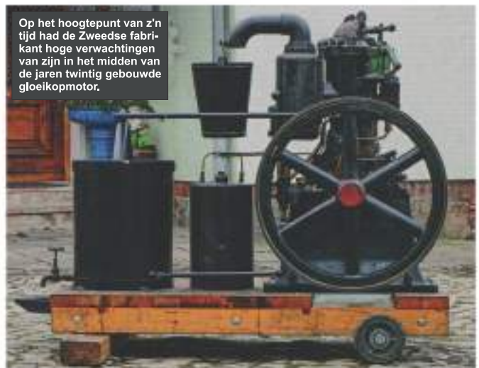
Snelheidsregeling als uniek verkoopargument en naamgenoot: de centrifugaalregelaar wordt bestuurd door de krukas met behulp van een hoekaandrijving, en de daarmee gecombineerde injectiepomp wordt bestuurd door een excentriek.
