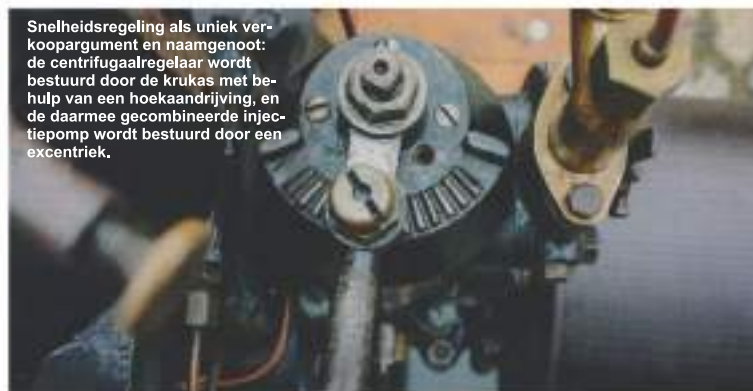
De inspuitshoeveelheid en daarmee de snelheid kan worden aangepast met behulp van de hendel op de controller. De luchtinlaat vindt plaats via het carter, afhankelijk van het toerental.
