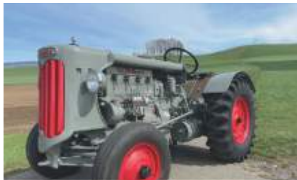
Het type D-100 was een tractor met een 4 liter Hürlimann viercilindermotor van 36 pk gebouwd vanaf 1946 Dit ontwerp was volgens Francesco Cassani, de oprichter van Same, zo baanbrekend dat hij de trekker omschreef als de "Rolls-Royce" onder de tractoren.
