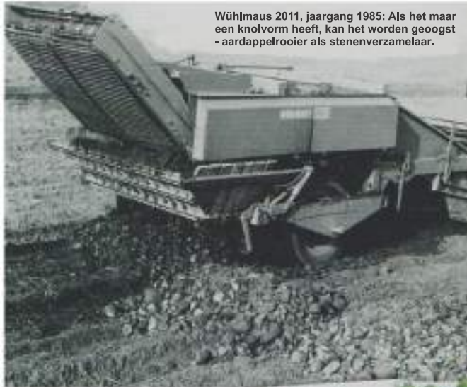
Wühlmaus 1733 nogmaals: De rooier werkt met een aftakstoerental van 540 tpm. Op wens was er ook een bunker van 3,5 ton.
