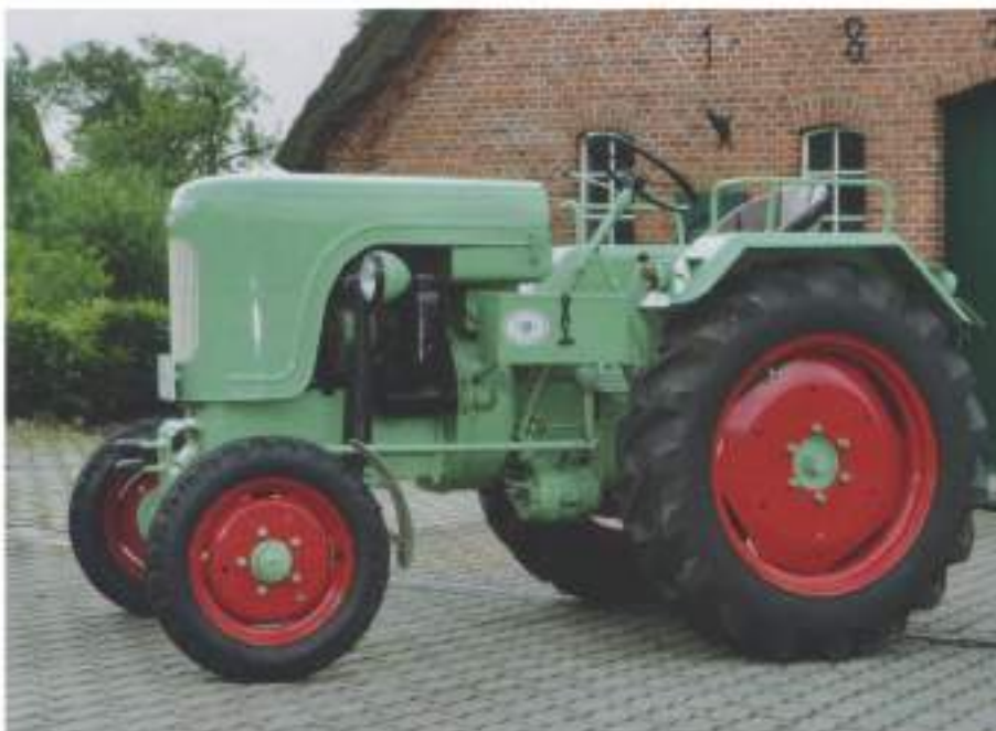
Kort en hoog: Met een lengte van 2,75 m lijkt de AS 20 WB dankzij zijn hoge banden vrij compact; De afkorting "WB" duidt op de variant met hoge wielen, het standaardtype heette "WA".
