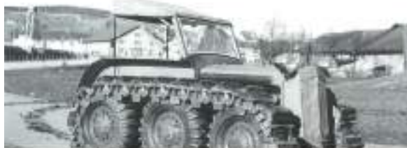
In 1937 werd een zescilinder benzine/petroleummotor van 60 pk in ontwikkeld die gebruikt zou worden in de komende industriëletractoren. Maar de motor werd al in 1938 gebruikt in het prototype van de rupstrekker 6MS75. De rupsen van deze trekker werden op spanning gebracht door het oppompen van de luchtbanden.
