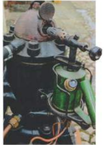
Het (gesimuleerd) voldoende lang voorgloeiën met behulp van een brander hoort hier ook bij de start.
