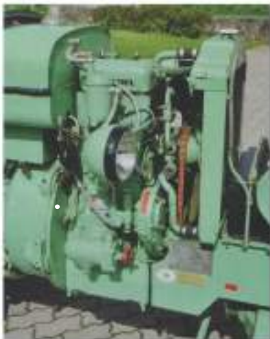
Henschel onder de motorkap: Bischoff installeerde MWM- en Henschel-motoren; De AS 20 WB heeft een watergekoelde Henschel 515 DE tweecilinder aan het werk.
