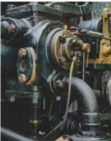
Voordat de bougie en de hoogspanningsmagneet het overnemen, nam de ontstekingsstang het genereren van de vonk over.
