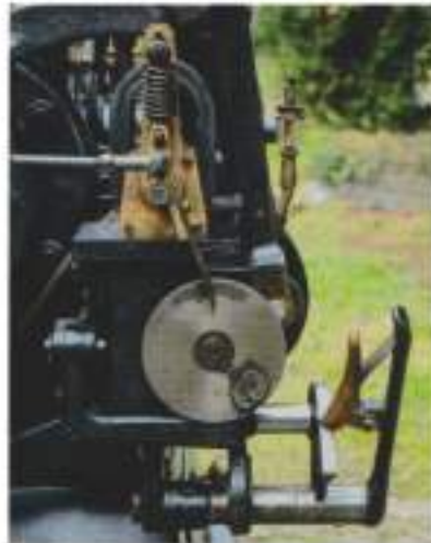
...niet meer kan worden bevestigd. De afslagmagneet wordt bediend door de nokkenschijf aan het uiteinde van de massieve bedieningsgas.
