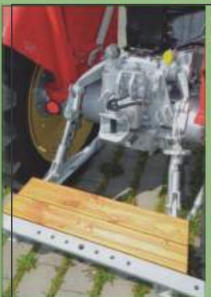
Mooie "meerrijder" van hout: de powerlift hydrauliek komt van een Schlüter Super 550.
