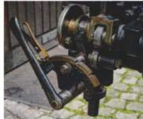
Multifunctionele hendel: De "ijzeren handgreep" is niet alleen belangrijk voor het starten van de motor, maar zorgt er ook voor dat de pal kan vergrendelen.
