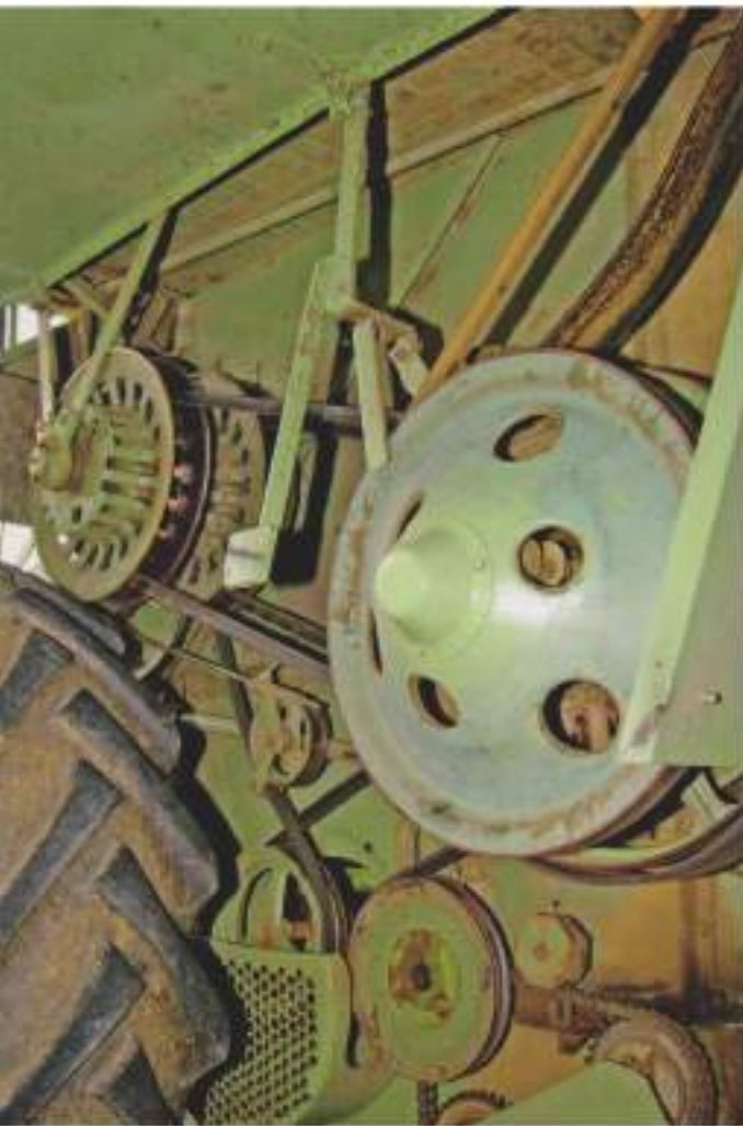
Twee V-snaren brengen de kracht over op de dorstrommel. De snelheid van de trommel kan hydraulisch worden geregeld van 650 tot 1400 tpm, zodat deze kan worden aangepast aan veranderende oogstomstandigheden en gewassen.
