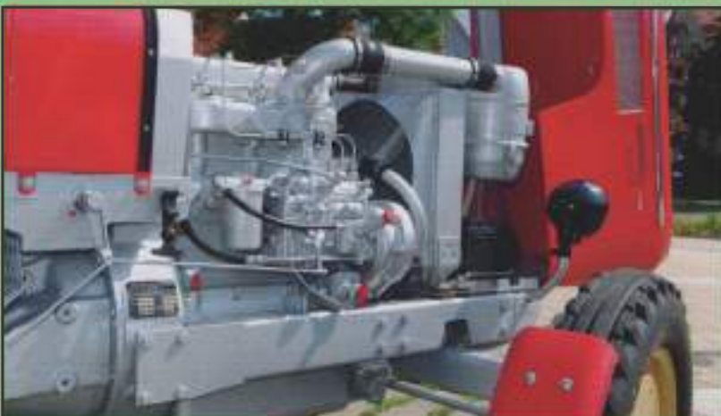
Kijk eens naar de injectiezijde van de driecilindermotor met directe injectie uit de SDW-serie.
