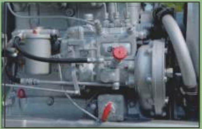
De originele injectiepomp zit op de 3240 cc diesel met 42 pk type SD 105 W3.
