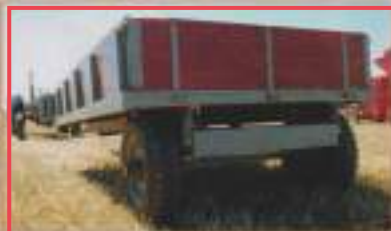
Originele Ferguson kiepwagen: Deze enkelassige kiepwagen is ontworpen voor een maximale belasting van drie ton.
