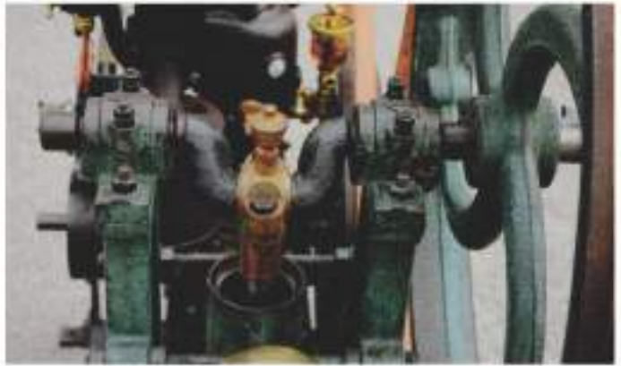
Ook de ogenschijnlijk met de hand gesmede krukas van de pomp heeft smeermiddel nodig: een klein oliespuitje is voldoende. Japy leverde klanten het complete ensemble.
