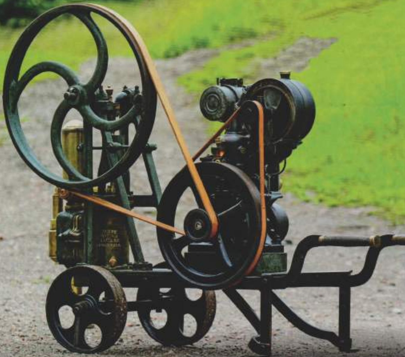
Prachtige combinatie, vakkundig gerestaureerd: De Japy 13 E met plunjerpomp werd vroeger door een wijnmaker gebruikt om de wijn uit grote vaten in de kelder naar boven te pompen.
