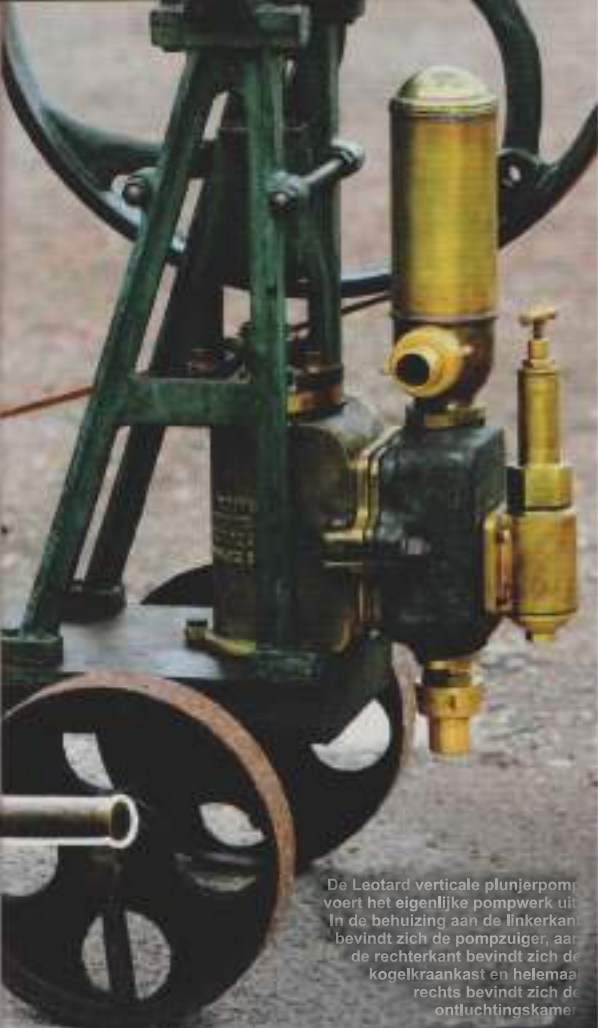
Ook de ogenschijnlijk met de hand gesmede krukas van de pomp heeft smeermiddel nodig: een klein oliespuitje is voldoende. Japy leverde klanten het complete ensemble.
