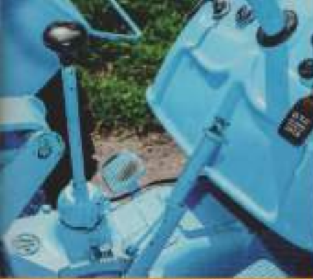
Minimalistisch maar functioneel: de WT 20 heeft een vijfversnellingsbak en geen instrumenten.
