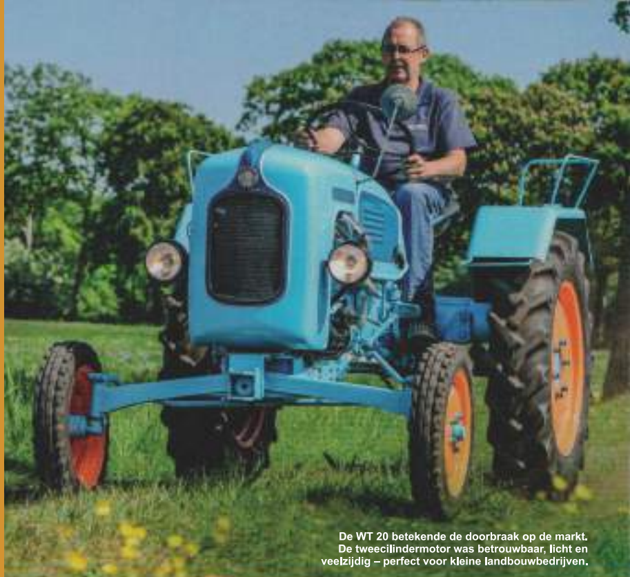
Minimalistisch maar functioneel: de WT 20 heeft een vijfversnellingsbak en geen instrumenten.
