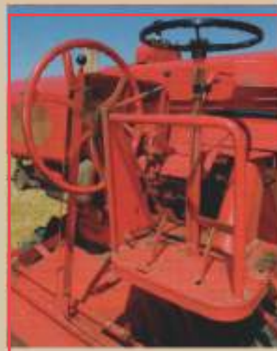
Blootgesteld aan weersinvloeden: In de bestuurscabine valt het grote bedieningswiel voor het mechanisch heffen van de maai-eenheid op.
