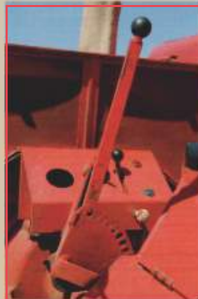
Met snelheidsregelaar: Brede hendel voor traploze snelheidsregeling.
