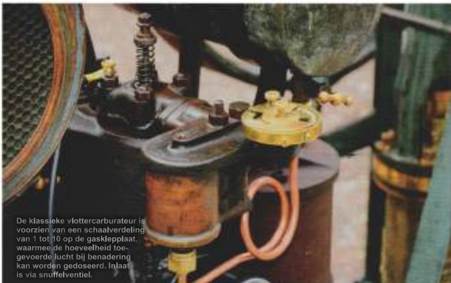
Prachtige combinatie, vakkundig gerestaureerd: De Japy 13 E met plunjerpomp werd vroeger door een wijnmaker gebruikt om de wijn uit grote vaten in de kelder naar boven te pompen.
