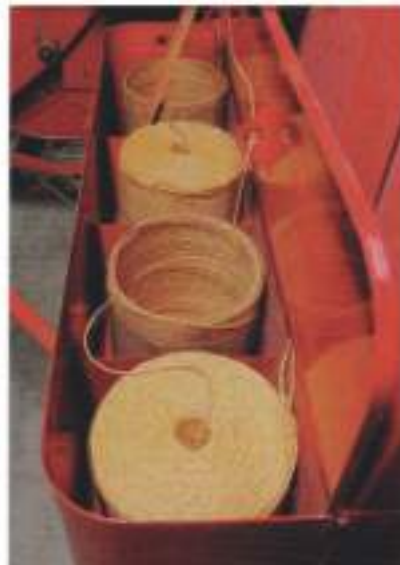
Het open touwcompartiment met reserverollen is al aan het uiteinde van de eerste rol bevestigd, waardoor het binden zonder onderbreking kan doorgaan.
