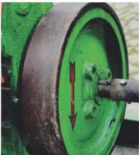
De Wolseley start eenvoudig via het vliegwiel en start meestal direct.
