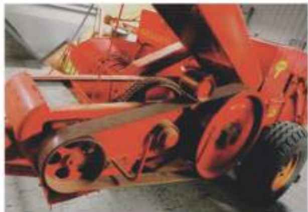
De AP 51 heeft een krachtige riemaandrijving met een vlakke riem, terwijl zijn opvolger, de AP 52 K, een aandrijfketting gebruikt.
