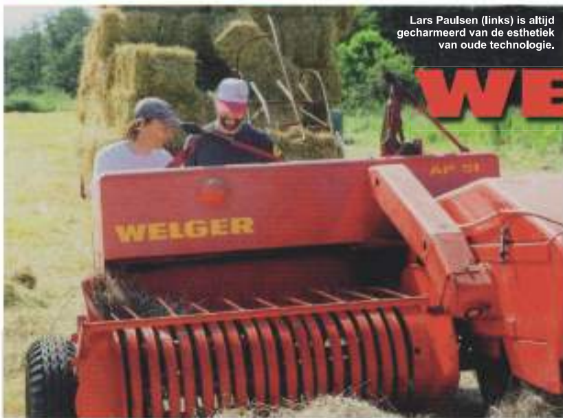
Het wiel loopt over de geperste balen, activeert het bindproces en regelt zo de baallengte.
