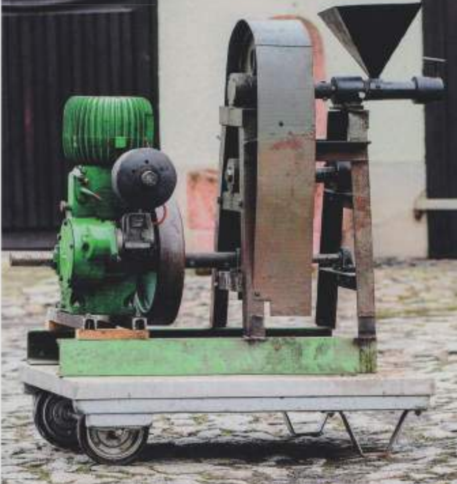
De schuine buis wordt gebruikt om water af te voeren, motorolie wordt onder het typeplaatje gevuld.
