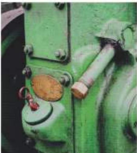
De schuine buis wordt gebruikt om water af te voeren, motorolie wordt onder het typeplaatje gevuld.
